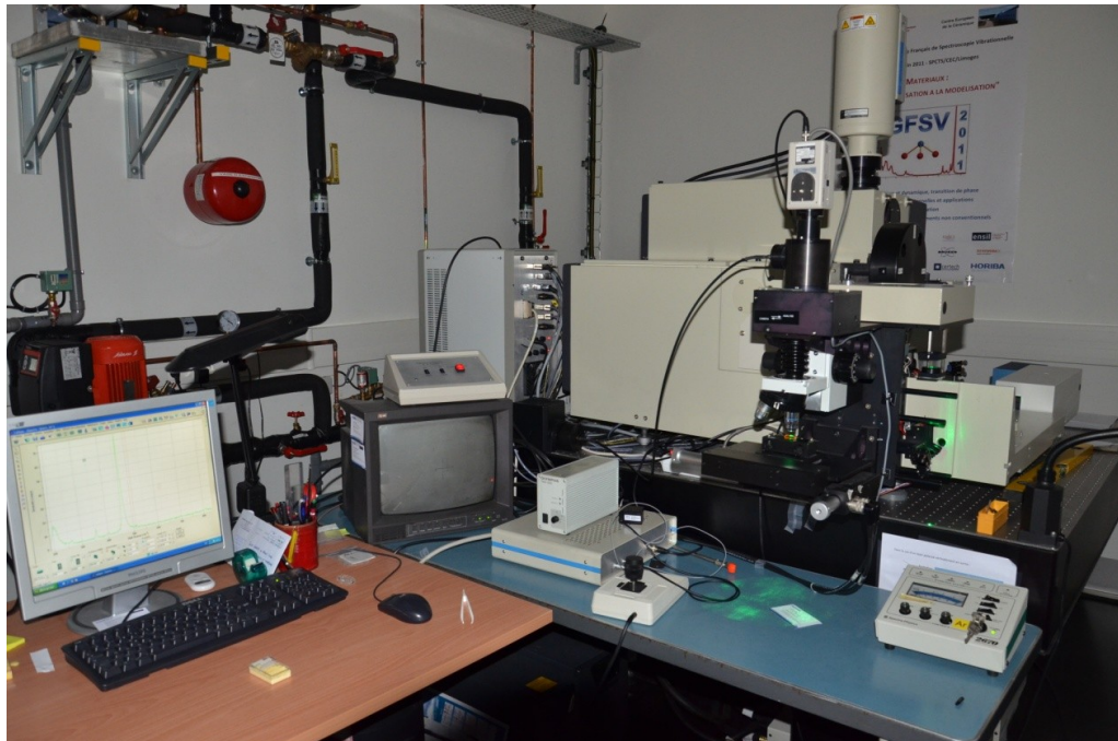
Figure II- 7. Schéma du dispositif expérimental du spectromètre T64000
