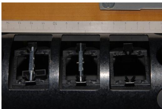
FIGURE 3.9 – Réservoir situé au cœur du réacteur nucléaire ayant pour objectif de servir de cible pour l'expérience GAMS5 de mesure de durée de vie. Le réservoir contenait du cristal de  $Gd_2O_3$  sous forme de poudre.
