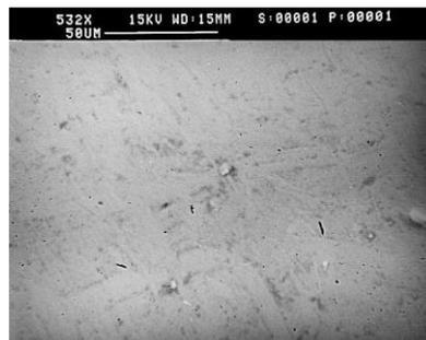
**Figure I-66 :** Image (par microscopie électronique à balayage) du revêtement CrN sur AISI 304 (Jagielski, 2000).
