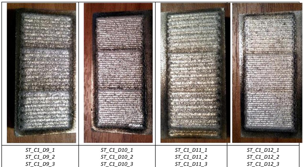
**Figure II-13 :** Quelques échantillons de dépôts 2D de Stellite 6.
