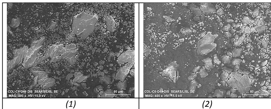
**Figure III-40** : Morphologie des débris d'usure : Colmonoy-52, 5 N et température ambiante.
