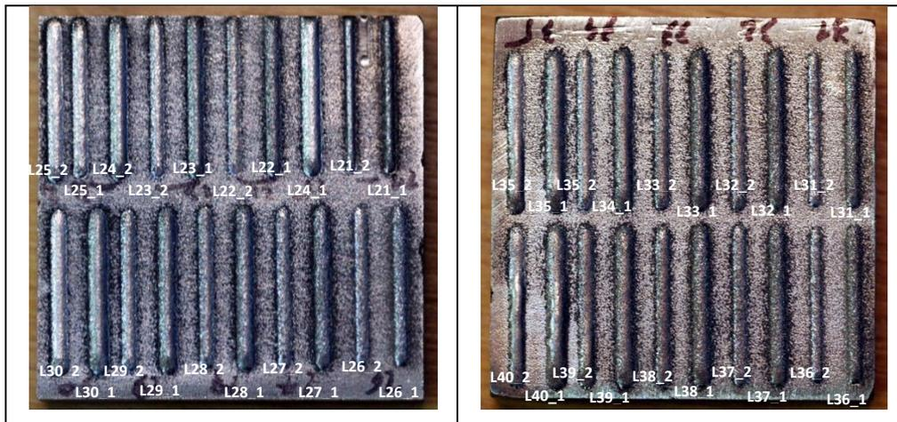
**Figure II-27** : Dépôt mono-couche en Colmonoy-52 par projection laser.
