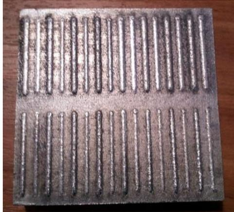
**Figure II-11:** Dépôts mono-cordon de Stellite6 sur 316L.
