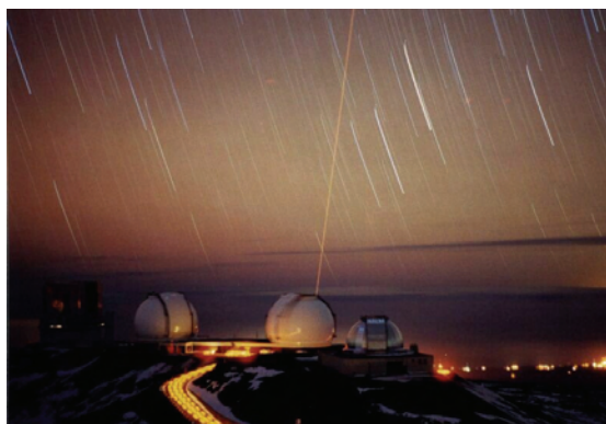
Figure 3 : Photographie du premier faisceau laser (au Keck) permettant de générer une étoile artificielle dans la haute atmosphère en y excitant les atomes de sodium. Cette étoile n'est pas visible à l'œil nu mais est assez lumineuse pour faire fonctionner l'optique adaptative du Keck. On peut observer sur cette image le trajet du faisceau laser à cause des phénomènes de diffusions Mie et Rayleigh qui se manifestent dans les basses couches de l'atmosphère (troposphère).
