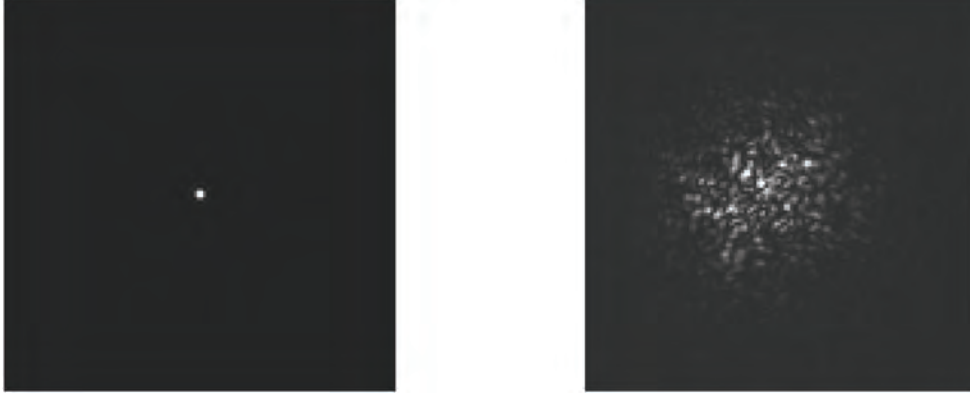
Figure 17 : On peut voir ici la différence entre une FEP sans turbulence atmosphérique (à gauche) et avec turbulence (à droite). Le D / r_0 est égal à 20. Source : [Thomas2006].
