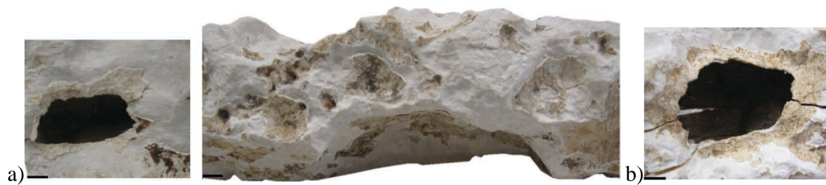
Fig. 40. Forages macroscopiques de la surface de a) AI_EL_POU2 et b) AI_EL_POU3. La barre d'échelle représentée par le trait noir est de 1 cm.
