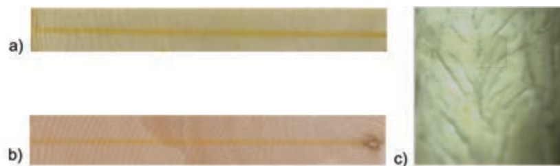
Fig. 70. Degradations par le faisceau de protons de 3Mev sur a) l'ivoire moderne, b) l'ivoire archéologique des Poulins et c. un des objets de la collection du Louvre.
