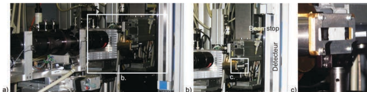
Fig. 74. Montage des analyses SAXS/WAXS au synchrotron BESSY, a) vue d'ensemble du dispositif de la MySpot, b) agencement du détecteur, du beamstop et c) de l'échantillon.
