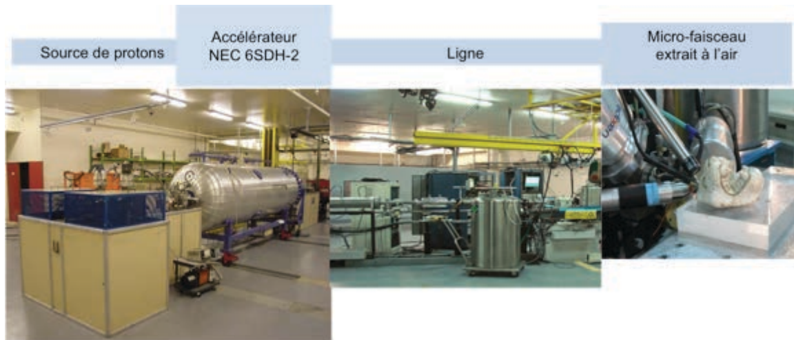
Fig. 64. Expériences à AGLAE avec les principales parties : la source de protons, l'accélérateur, la ligne d'accélération et le microfaisceau extrait à l'air.
