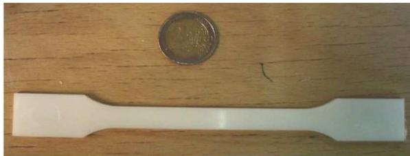
Figure 67. Éprouvettes obtenue par la presse à injecter JSW
