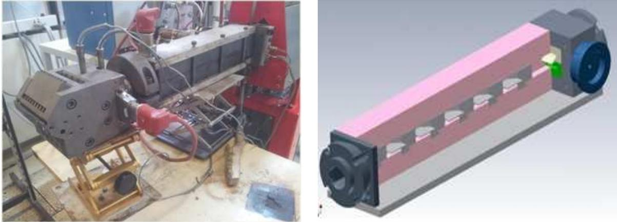
Figure 61. Photo du bloc mélangeur contenant les éléments multiplicateurs de couches (EMC) avec une filière plate (à gauche) et schéma en coupe du boîtier de coextrusion et du bloc avec les EMC (à droite)
