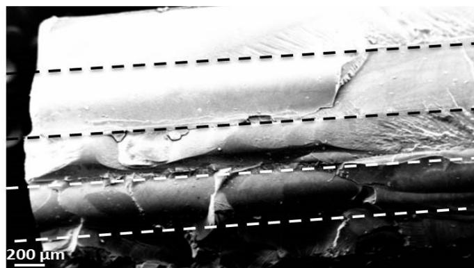
Figure 88. Micrographie de la surface cryofracturée dans le sens d'extrusion (sens longitudinal) du jonc structuré par coextrusion fibrillaire
