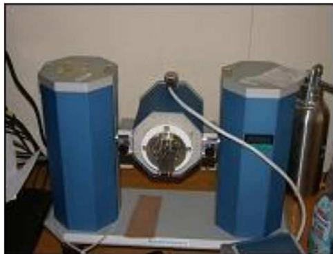
Figure 76. Photographie de l'appareil de DMTA Tritec
