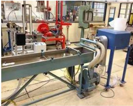
*Figure 58. Vue du bain d'eau de refroidissement et du granulateur*
