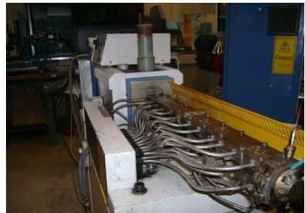
*Figure 57 : Extrudeuse bavis (HAAKE) du CNAM*
