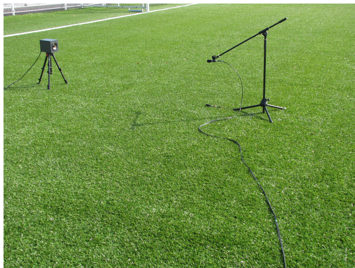
FIGURE 5.4 – Mesure d'impédance sur le terrain de football en gazon synthétique (terrain synthétique ).
