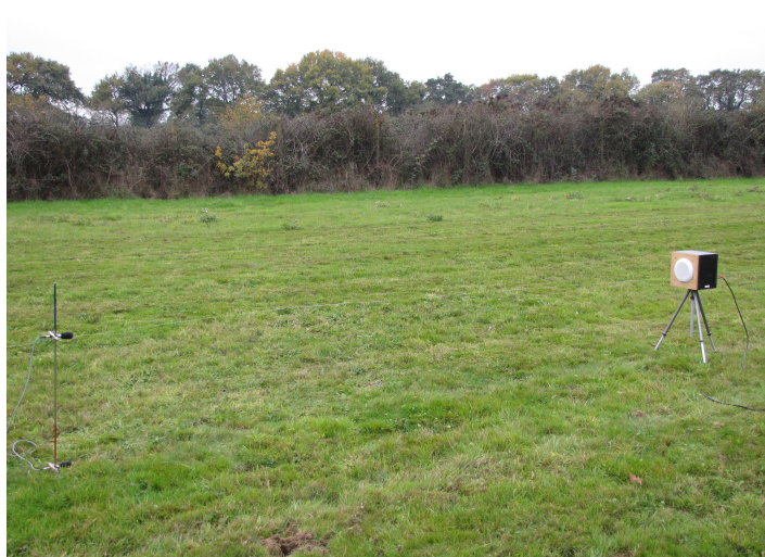
FIGURE 5.6 – Mesure d’impédance sur le terrain de l’Ifsttar (terrain herbeux naturel ).
