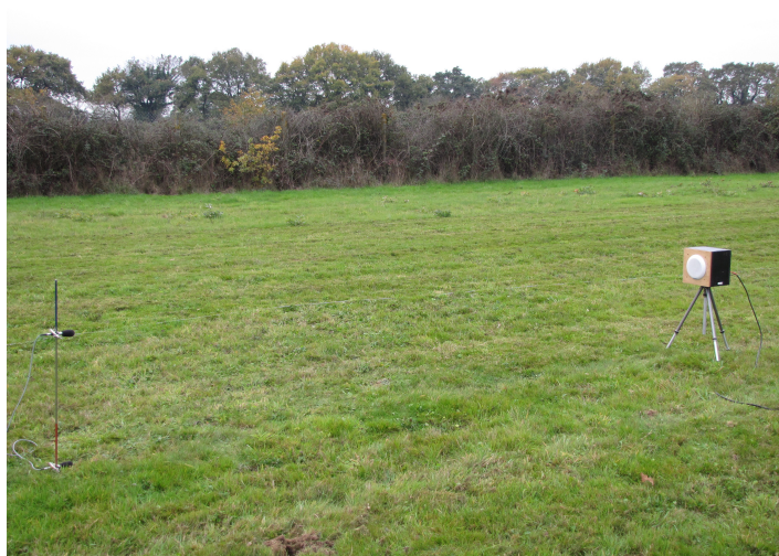
FIGURE 5.6 – Mesure d'impédance sur le terrain de l'Ifsttar (terrain herbeux naturel ).
