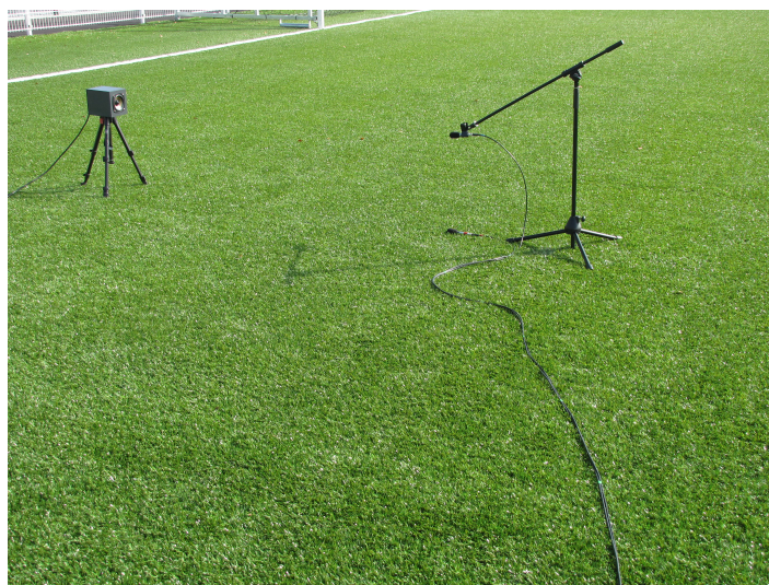
FIGURE 5.4 – Mesure d'impédance sur le terrain de football en gazon synthétique (terrain synthétique ).
