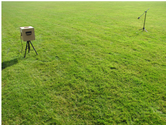
FIGURE 5.5 – Mesure d'impédance sur le terrain de football en gazon naturel (terrain gazon ).
