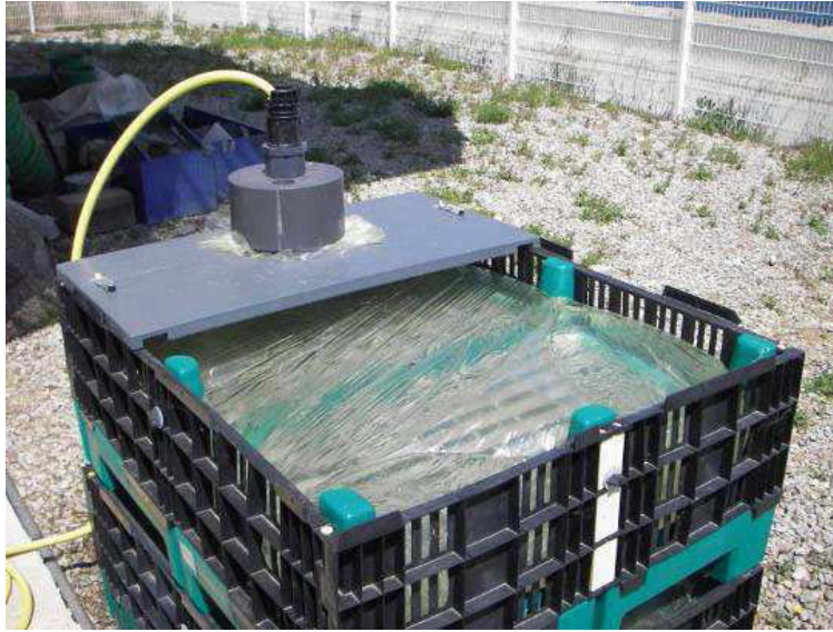
Figure 18 : Poches d'évaporation contenant de l'eau contaminée par les métaux
