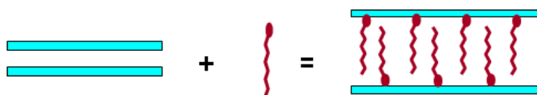
Schéma 3 : Représentation schématique de l'augmentation de la distance inter-lamellaire par des chaînes alkyles sulfates
