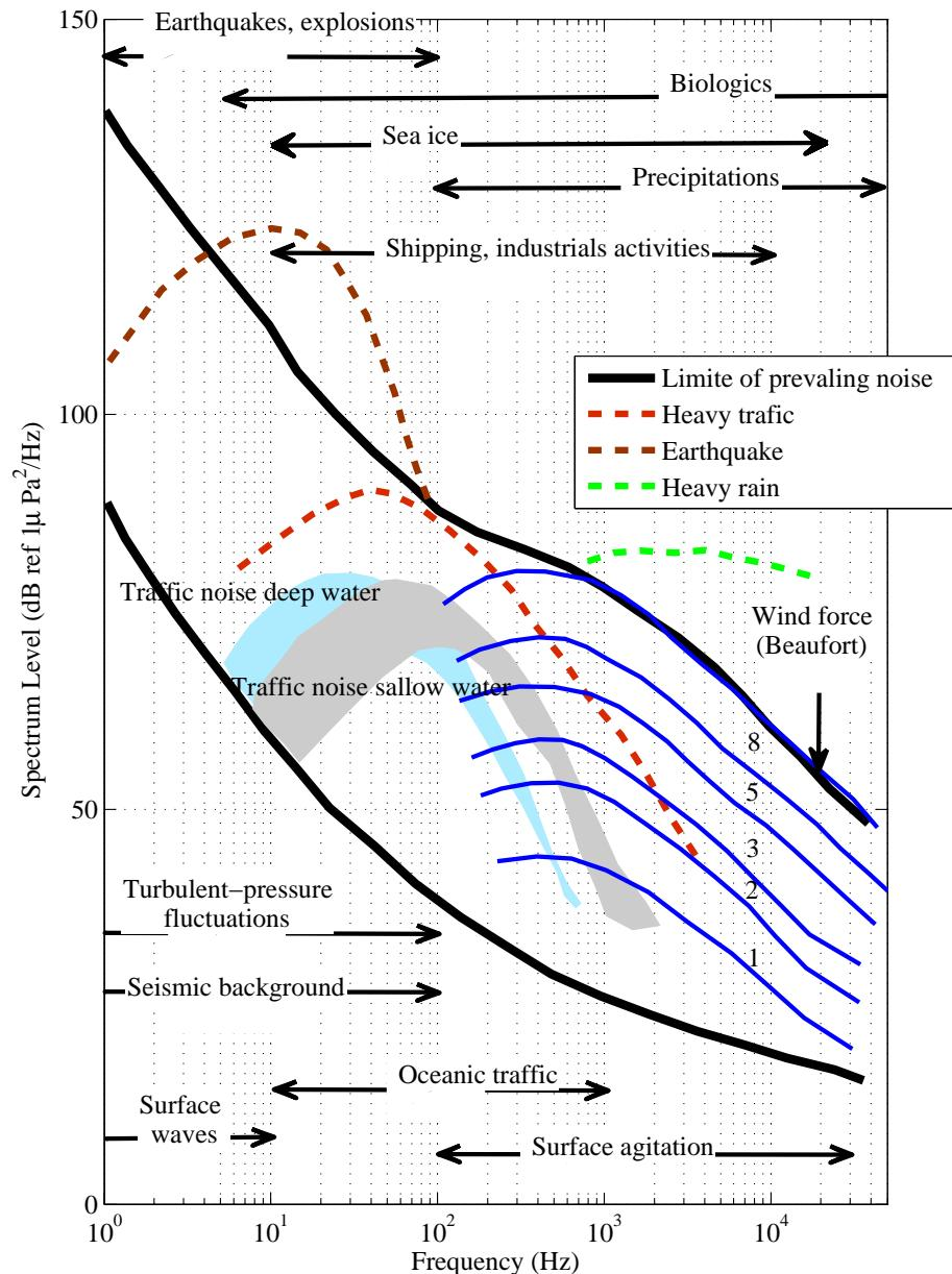
Figure 1.5: Spectres de Wenz du bruit océanique (source: [Wenz62]). Les trois principaux contributeurs au bruit ambiant sont le bruit de turbulence océanique (Surface waves), le trafic maritime (Oceanic traffic) et l'agitation de la surface océanique (Surface agitation). A ce bruit ambiant s'ajoutent des transitoires d'origine physique(tremblement de terre, glace de mer) et biologique.
