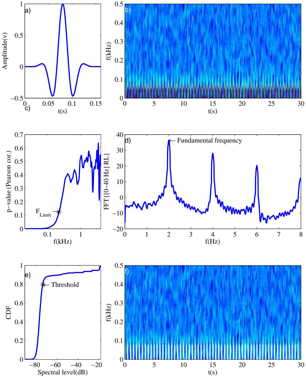
Figure 1.8: Elimination du bruit de vibration par seuillage du spectrogramme sur données simulées. (a) impulsion primaire ; (b) spectrogramme montant les bandes temps-fréquence contaminées ; (c) test de corrélation pour déterminer la largeur de la bande des impulsions ; (d) série de Fourier du niveau large bande (4–20 Hz) ; (e) fonction de densité cumulatif empirique et seuil ; (f) spectrogramme nettoyé des impulsions (pixels blancs).
