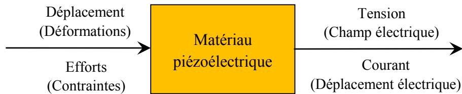
FIG. 2.1- Effet piézoélectrique direct.
