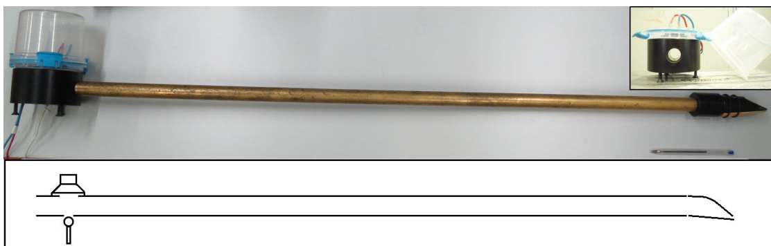
FIGURE 1.15 – Haut : “Clarinette basse simplifiée” (un tube cylindrique à l’entrée duquel est monté un bec de clarinette basse avec une anche) équipée d’un système de contrôle composé d’un microphone et d’un haut-parleur colocalisés. Coin haut droit : Système de contrôle extrait de l’instrument. Bas : Schéma de l’instrument avec système de contrôle intégré.
