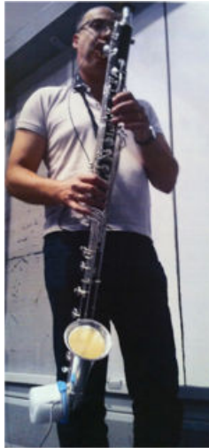
FIGURE 5.1 – Clarinette hybride équipée d'un microphone dans le bocal et d'un haut-parleur dans le pavillon.
