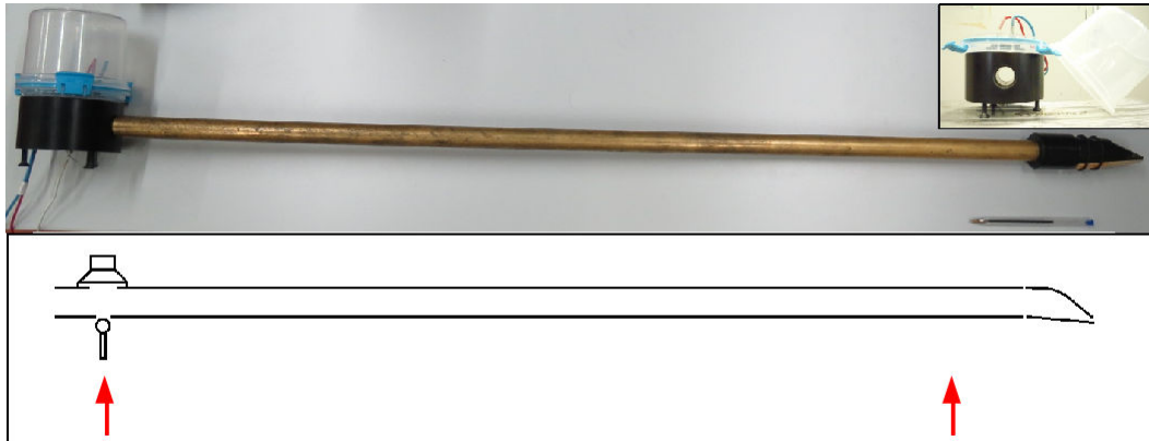
FIGURE 4.2 – Haut : “Clarinette basse simplifiée” équipé d’un système de contrôle composé d’un microphone et d’un haut-parleur colocalisés. Coin haut droit : Système de contrôle extrait de l’instrument. Bas : Schéma de l’instrument avec système de contrôle intégré. La flèche de gauche indique la position à 5 cm de la terminaison ouverte du tube, tandis que la flèche de droite indique la position à 9 cm de l’embouchure.
