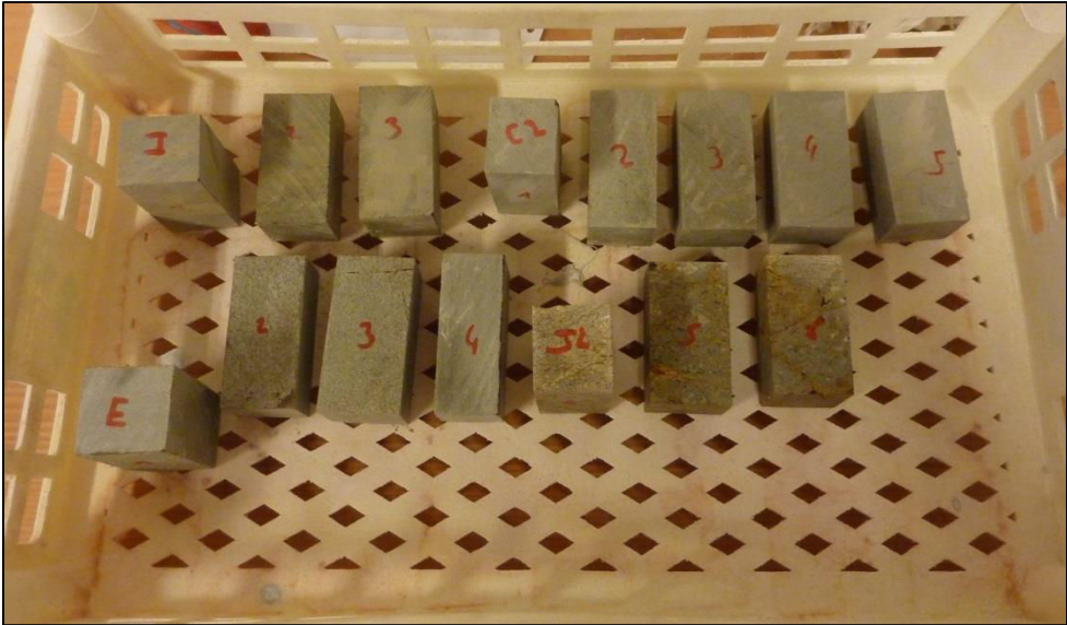
Figure 2.10 Photos des éprouvettes testées en compression uniaxiale
