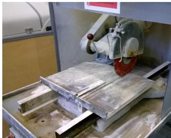
Figure 2.7 Photo du dispositif de taille et guidages
