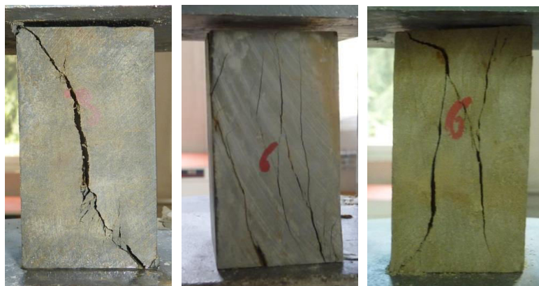
Figure 2.14 Exemples d'éprouvettes après essai : A gauche (site I) : rupture avec une seule fissure. Au centre (site B) et à droite (site L1) : fissuration généralisée.
