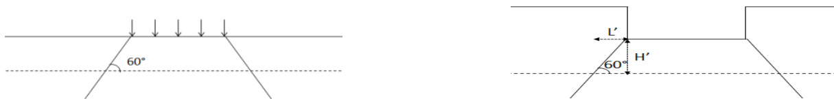
Figure 3.5. Principe d'épanouissement des contraintes dans le terrain : (a) sous un chargement, (b) sous un déchargement
