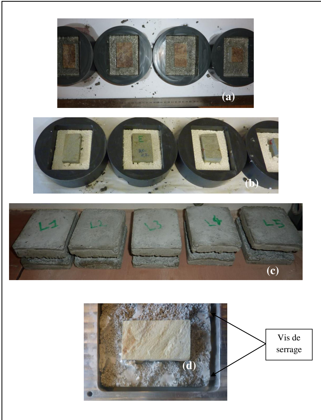
Figure 3.2 Les différentes étapes de préparation des éprouvettes. (a) Coulage de l'éponte inférieure. (b) Mise en place du coffrage en polystyrène et du ruban adhésif. (c) Eponte supérieure coulée, coffrage et adhésif enlevés. (d) Mise en place de l'éprouvette dans la boîte de cisaillement et maintenue par un système de vis.
