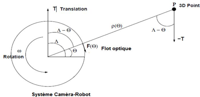
FIGURE 3.6 – Mouvement sphérique du système robot-caméra [Stratmann 2004].
