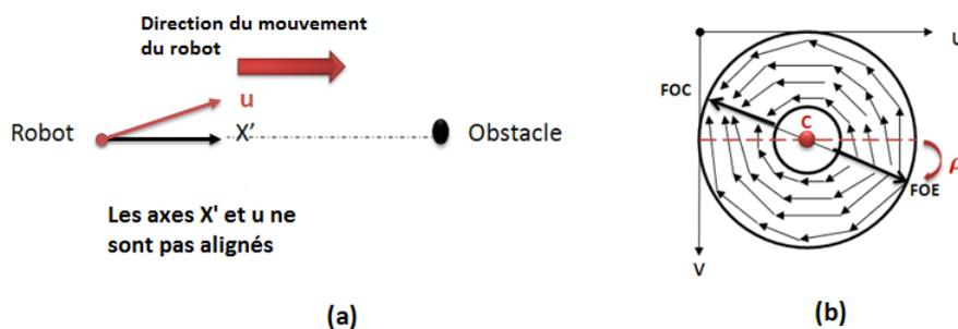
FIGURE 4.8 – Les positions des points FOE et FOC dans le cas où les axes du robot et du capteur ( $X'$  et  $u$ ) ne sont pas alignés. (a) Les directions des axes de translation du robot et du capteur ne sont pas alignés. (b) Les positions de FOE et FOC dans l'image omnidirectionnelle.
