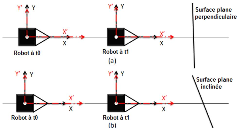
FIGURE 5.3 – Deux situations de mouvement du capteur para-catadioptrique ( $X, Y$ ) embarqué sur un robot ( $X', Y'$ ). (a) Translation le long de l'axe  $X$  relativement à une surface plane perpendiculaire à l'axe  $X$ . (b) Translation le long de l'axe  $X$  relativement à une surface plane d'orientation quelconque.
