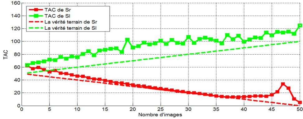
FIGURE 5.7 – Estimation du TAC avec la séquence para-catadioptrique (seq5) des obstacles ( $S_r$ ) et ( $S_l$ ). La courbe rouge illustre le TAC estimé de la surface plane ( $S_r$ ). La courbe bleue montre le TAC estimé de la surface plane ( $S_l$ ). La vérité terrain du  $\tau_{S_l}$  est illustrée en bleu pointillé et la courbe rouge pointillé représente la vérité terrain du  $\tau_{S_r}$ .
