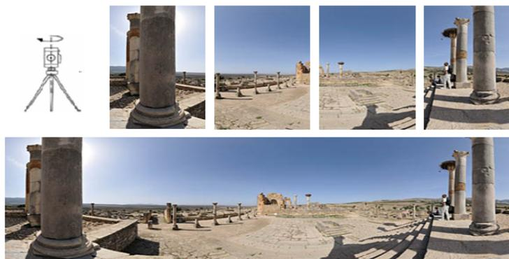
FIGURE 2.2 – Principe de système rotatif générant une image panoramique
