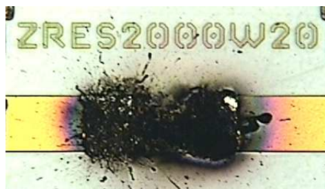
Figure 2-45 : Photographie optique en vue de dessus d'une résistance 2000W20 après destruction
