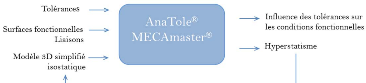
Figure 1-23. Entrées/ sorties MECAmaster® et AnaTole®.
