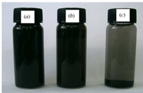
Figure 13. Photographie de suspensions dans l'eau après 2 mois de repos avec des NTC fonctionnalisés a) \text{COOH} , b) \text{COO}^- et c) des NTC bruts [96].
