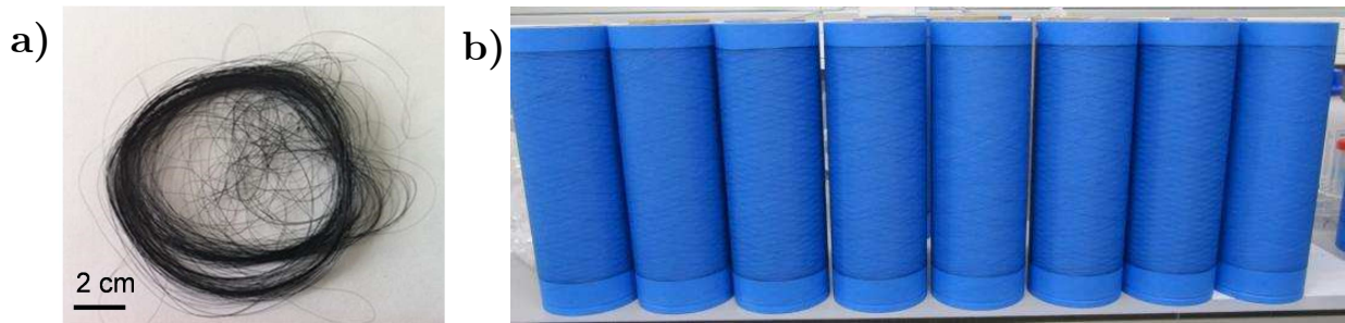
Figure 4. a) Photo d'une fibre enroulée mesurant une centaine de mètres, b) photo de plusieurs rouleaux contenant environ 100 m de fibre chacun.
