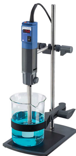
Figure 11. Photo d'un appareil Ultra-Turraz T25 de la marque IKA.
