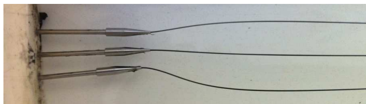
Figure 5. Formation de trois fibres par coagulation d'une suspension de NTC/PVA en présence de sulfate de sodium.
