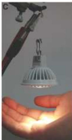
Figure 35. DEL éclairée par l'intermédiaire d'une fibre 100% NTC obtenue par voie humide [137].
