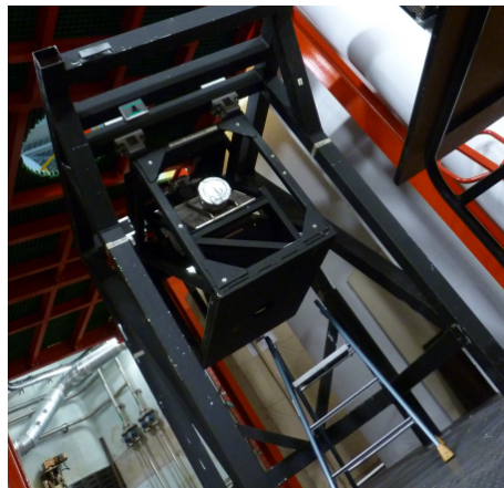
FIGURE 82 – Miroir défecteur électrostatique (donné par TRIUMF), permet une réorientation de 90^\circ du faisceau entre les lignes horizontale et verticale.
