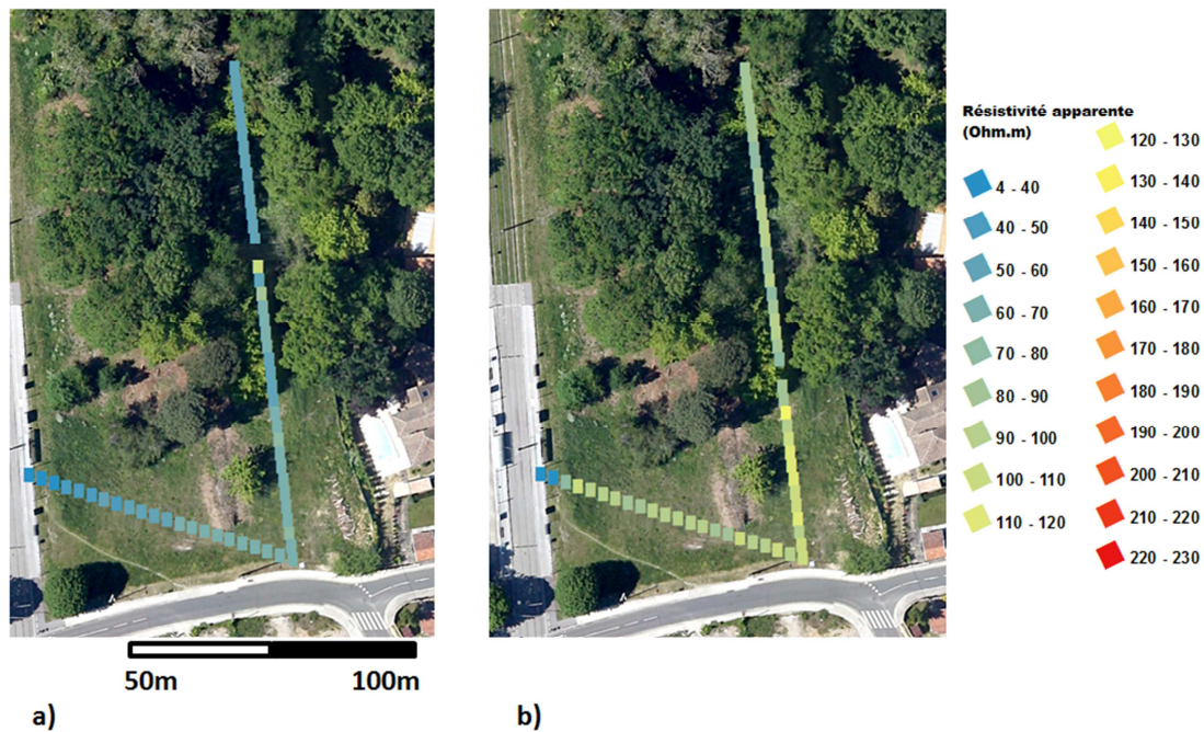
Figure 2.17 : Cartographie électromagnétique de la parcelle n°3, a) champ vertical, b) champ horizontal.
