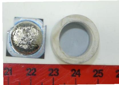
**Figure II.13** : Photographie d'un bain Sn-Si sur un substrat Si d'orientation (111) à gauche, et d'un creuset en BN à droite (nuance HIP/ fournisseur MCSE) après manipulation (bain Sn-2,6m%Si à 1170°C après 4 h de croissance).
