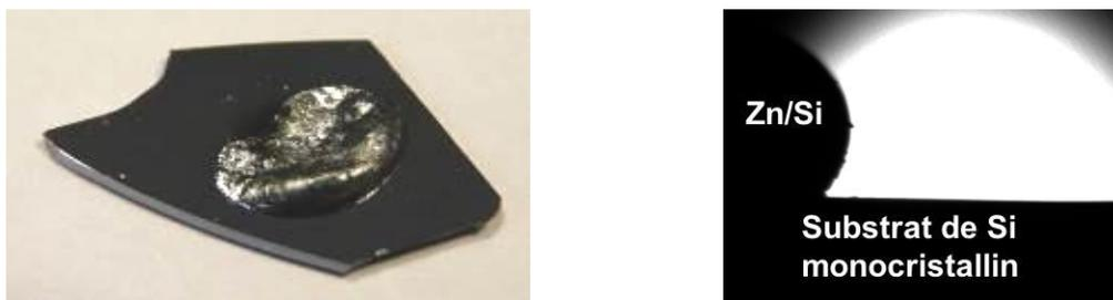
**Figure II.8 :** Goutte de zinc liquide sur un substrat poli de silicium monocristallin (111) à 900°C sous flux d'Ar/2.5% d' $H_2$  BIP à pression atmosphérique.
