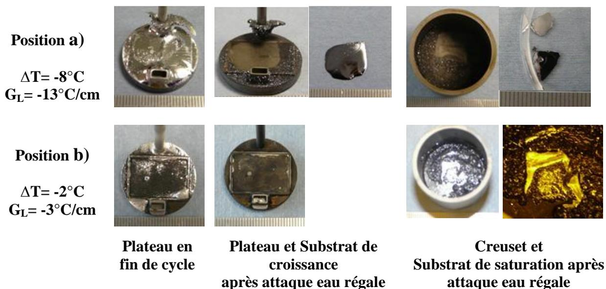
**Figure IV.3 :** Photographies des éléments constituant le système expérimental pour deux positions du creuset par rapport aux spires : phase de saturation de 3 h et phase de croissance de 2 h à  $1040^{\circ}\text{C}$ .
