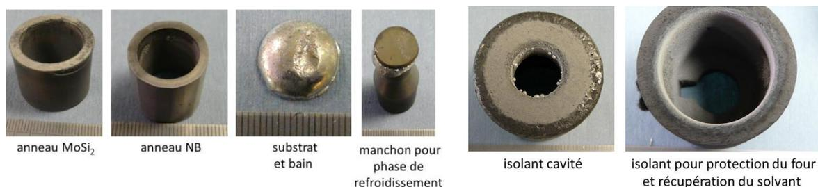
**Figure C.2 :** Ensemble des composants constituant le second dispositif expérimental pesés pour le bilan de masse suite au procédé d'EPLS pour la détermination du flux d'évaporation et du pourcentage de solvant récupéré.
