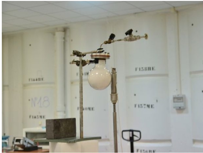
FIGURE 6.1 – Ampoule en verre remplie de la poudre de ^{40}\text{Ca} placée auprès d'une source de neutrons .
