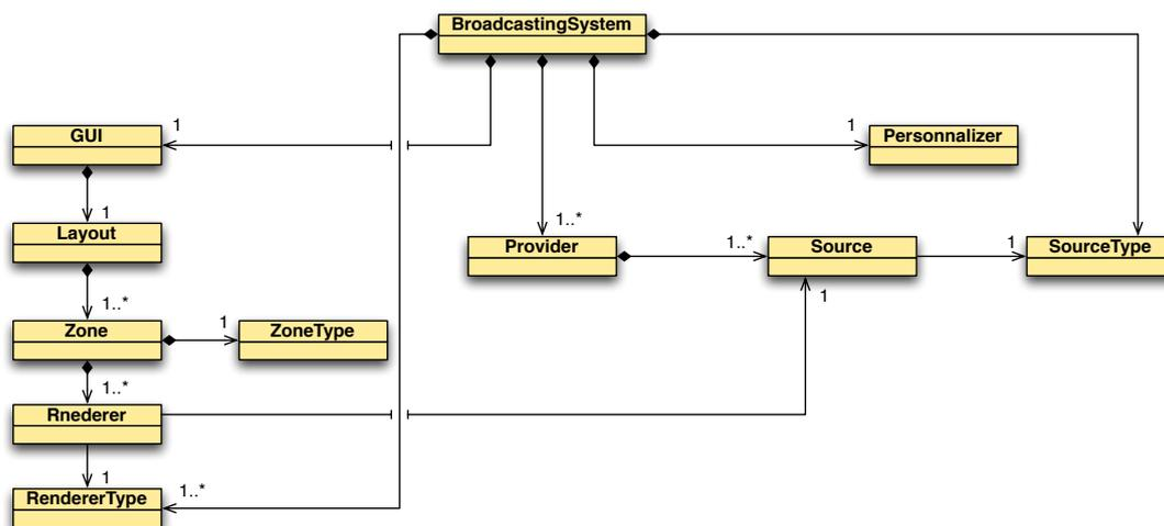
FIGURE 9.3 – Représentation simplifiée du métamodèle d'architecture de YOURCAST
