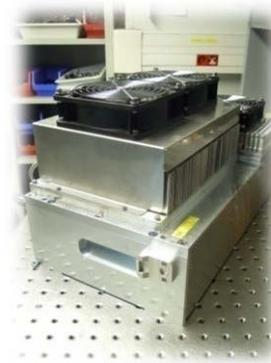
Figure 24 : Schéma de principe (a) et photographie (b) du microlaser amplifié de TeemPhotonics
