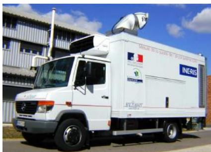
Figure 5 : Photographie d'un exemple de camion LIDAR (Ineris)
