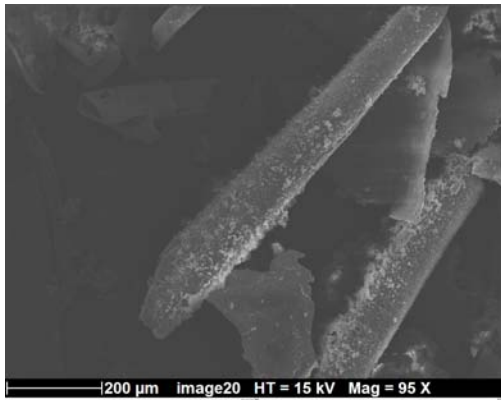
Image V-15. Images MEB de précipités contenus dans les solutions de lixiviations des échantillons de verres Planilux altérés pendant une durée comprise entre 236 et 260 jours.
