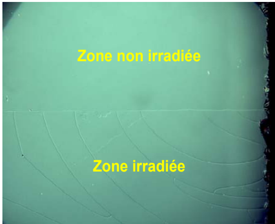
Image IV-4. Observation au microscope optique de fissures sur la surface irradiée des échantillons de verre Spectrosil ayant reçus des fluences de 3,2 \times 10^{12} \text{ Au/cm}^2 et 1,3 \times 10^{13} \text{ Au/cm}^2 .
