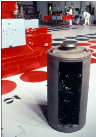
Image I-3. Prototype d'un colis de vitrification de déchets HAVL (hauteur 1,1 mètres, diamètre 43 cm) [15].
