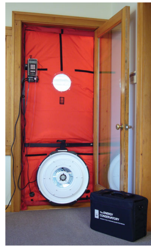
FIGURE 1.9 – Test de la porte soufflante pour mesurer le débit d'infiltration
