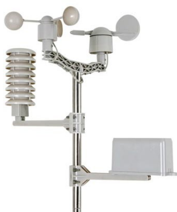
FIGURE 1.6 – Station météorologique pour audit énergétique. Source Econologie.
