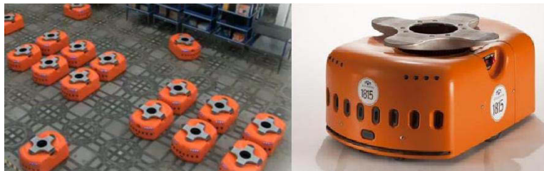
FIGURE 1.1 – Le robot unicycle KIVA à deux roues directionnelles [Systems 13]
