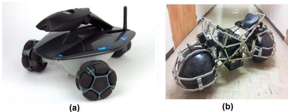
FIGURE 3.1 – Exemple de deux robots mobiles holonomes : (a) utilisant des roues à galets [Asama 95] et (b) ayant des roues sphériques [Tomsguide 12].
