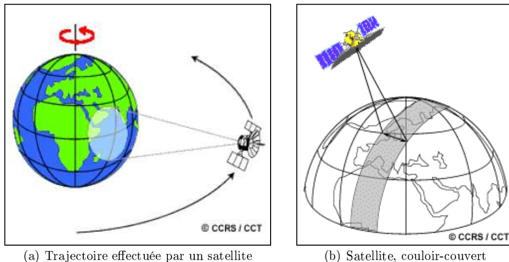
FIG. 2.5: Trajectoire et couloir-couvert d'un satellite
