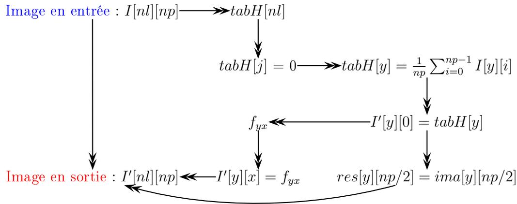
FIG. 4.9: Codage simplifié de la FFT en dimesion 2
