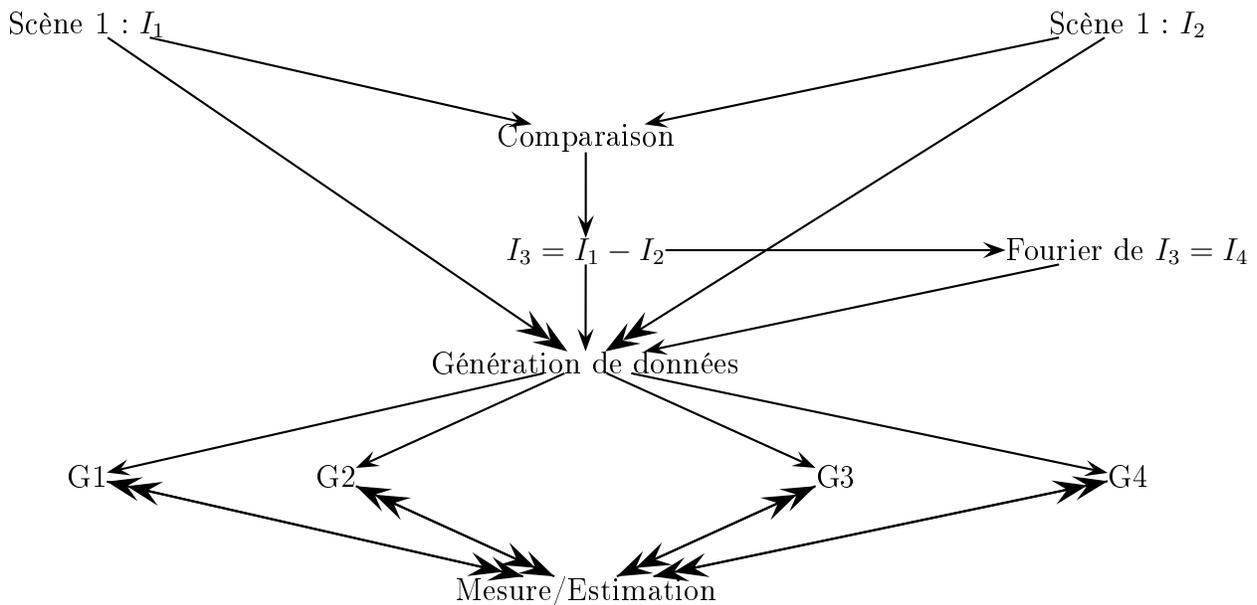
FIG. 4.22: Modèle mesurant l'évolution de deux scènes avec un prétraitement
