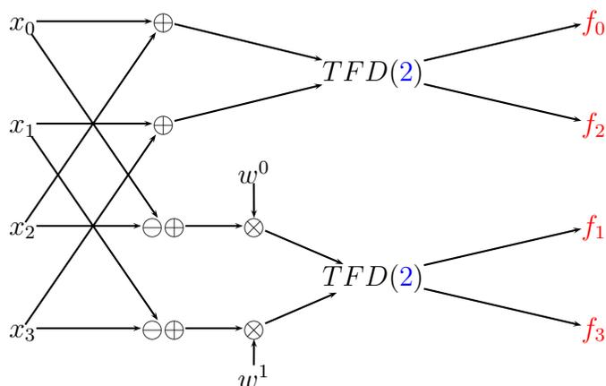
FIG. 4.3: Schéma complet de l'algorithme fréquentiel de Cooley-Tukey
