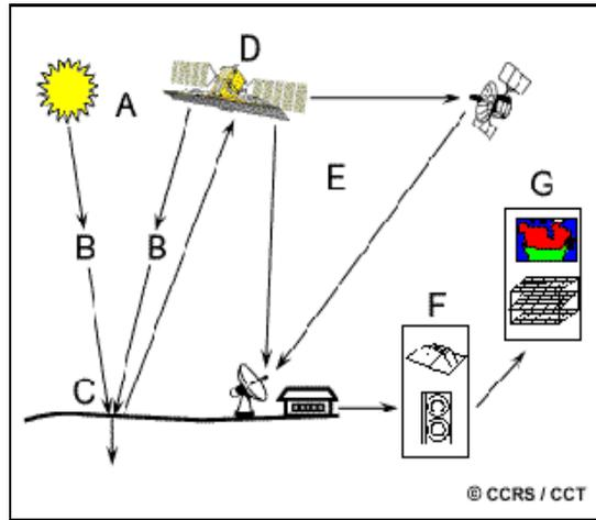
FIG. 2.1: Principe de l'acquisition de l'information par télédétection [9]
