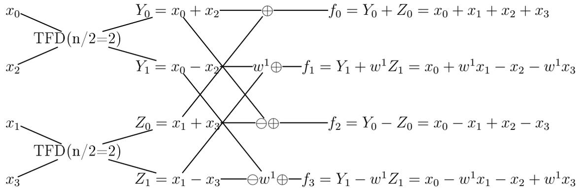
FIG. 4.1: Construction de  $f_j$  : étage de papillon
