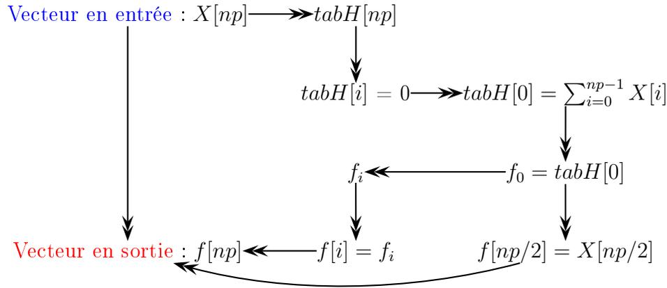
FIG. 4.6: Codage simplifié de la FFT en 1D
