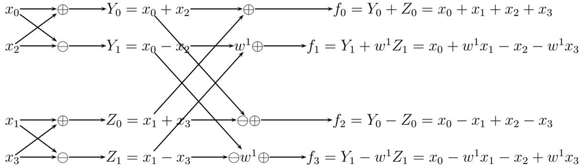
FIG. 4.2: Schéma complet de l'algorithme temporel de Cooley-Tukey
