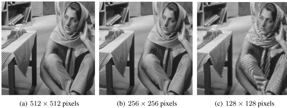
FIGURE 1.4. Effet de moiré provoqué par une résolution trop faible
