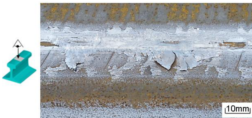
Figure V.1-14 : Délaminage des îlots de phase blanche sous forme de languettes
