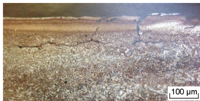
Figure V.1-20 : B360 : Fissure s'initiant d'un îlot de phase blanche.
