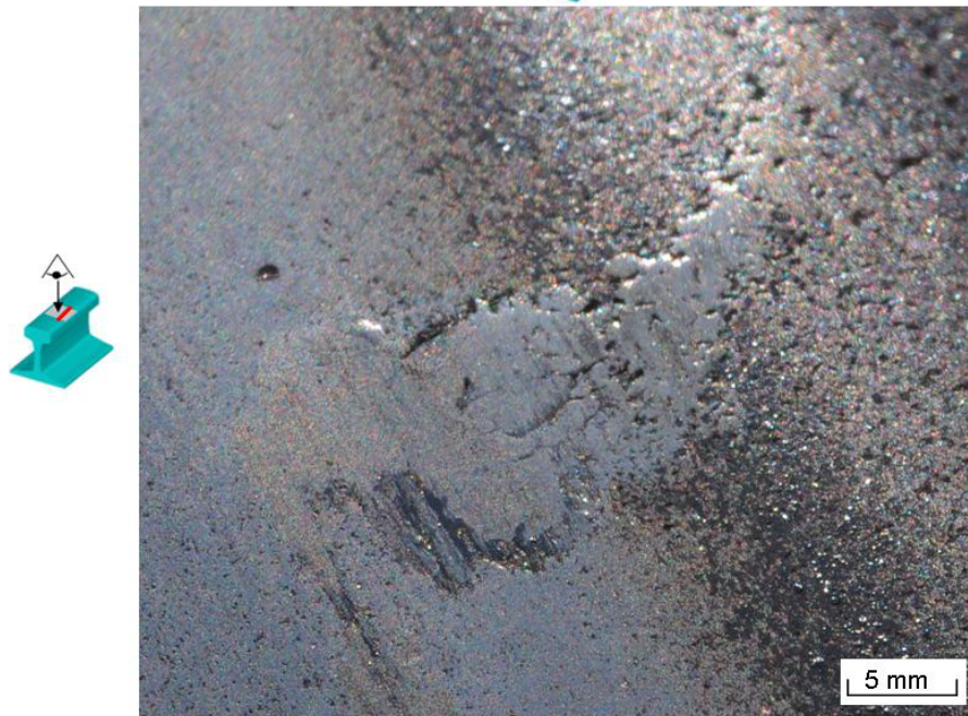
Figure V.1-13 : Îlot de phase blanche en périphérie de la bande de roulement sur la nuance B360
