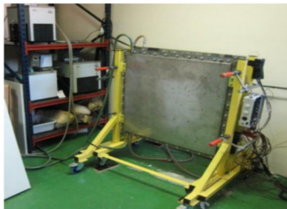
FIGURE 5.3 – Banc d'expérimentation pour les mesures fluxmétriques sur la planche à clous contenant du MCP
