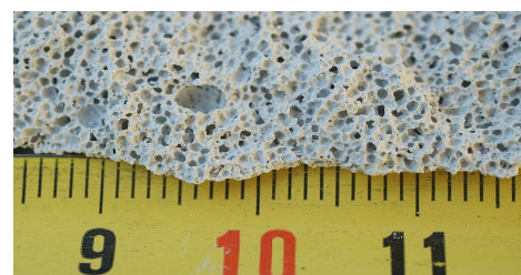
(b) Alvéoles formées pendant la cuisson par autoclavage grâce à la poudre d'aluminium
