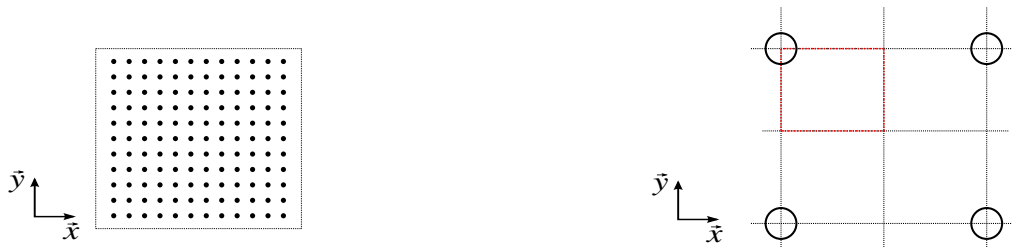
(a) Coupe de la planche à clous. Les points noirs correspondent aux clous installés.
