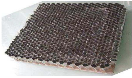
(a) Nid d'abeille métallique comme matrice conductrice. Grande surface de contact matrice/MCP et fonction conteneur. Exemple de [45].
