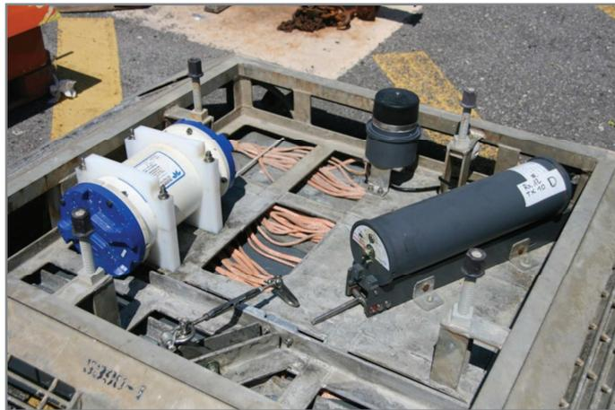
Photo II- 2 : Ensemble de batterie supplémentaire et largeur acoustique de la base de la cage.
