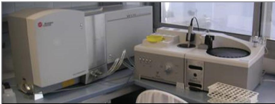
Figure Annexe 1 : Granulomètre à diffraction laser *LS 13320 Beckman & Coulter*.
