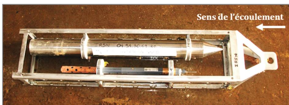
Photo III- 1: Sonde multiparamètres et piège à sédiments placés dans leur cage de protection à l'Eygoutier
