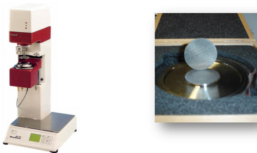
Figure 6: Photographie du Rhéomètre RS150 et d'une géométrie striée de type plan/plan.
