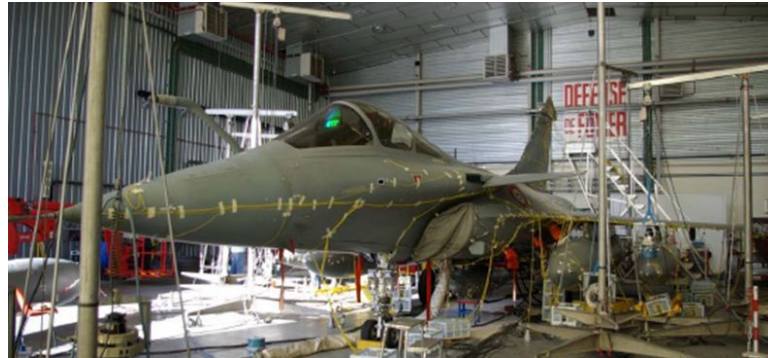
FIGURE 1.12 – Avion Rafale préparé lors d'un essai de vibration au sol (GVT)
