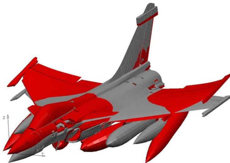
FIGURE 1.1 – Exemple : mode de flexion voilure d'un Rafale
