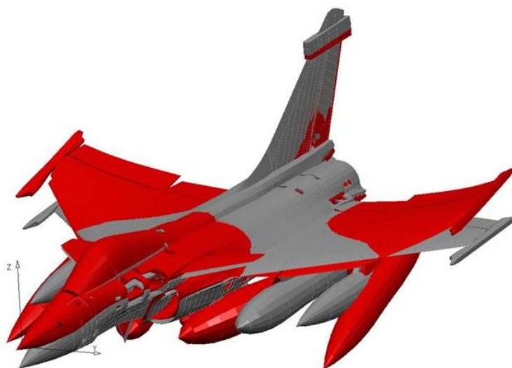
FIGURE 1.1 – Exemple : mode de flexion voilure d'un Rafale
