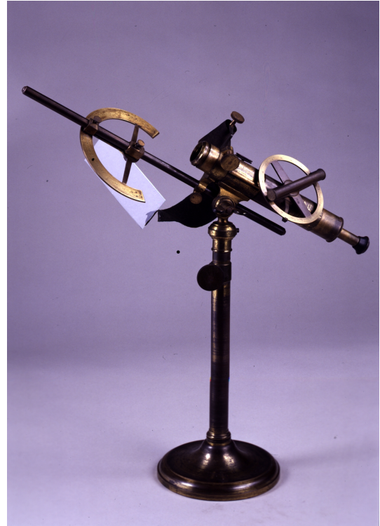
FIGURE 1.4 – Gravure du polarimètre d'Arago et photographie de l'appareil conservé à l'Observatoire de Paris. (Crédit : Observatoire de Paris)
