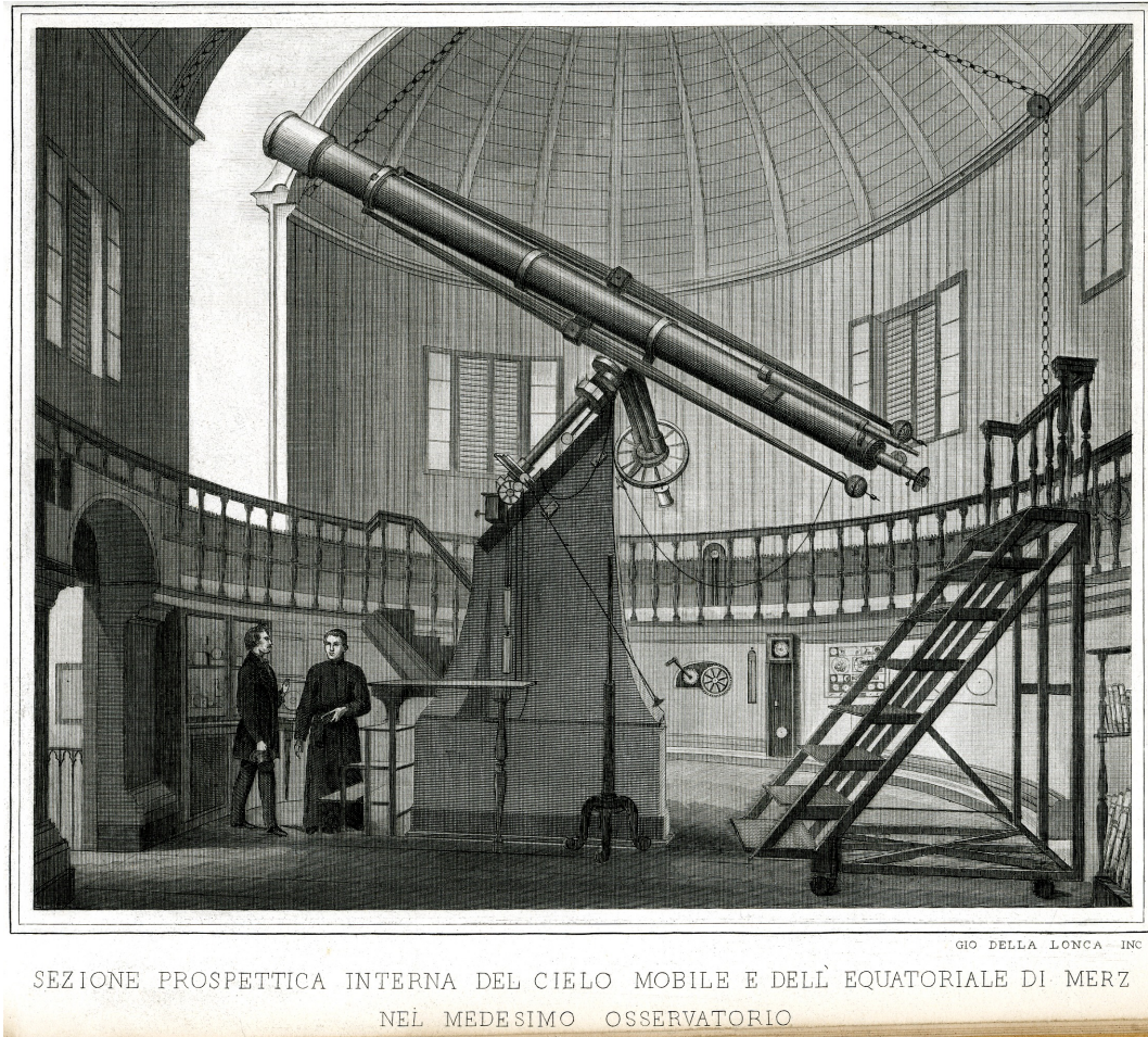
FIGURE 5.3 – Télescope sur monture équatoriale Merz de l’Observatoire du Collège Romain (Source : Observatoire de Paris).
