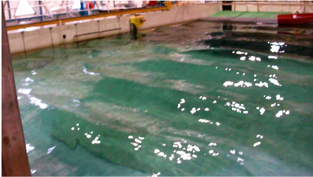
Figure VII.7 – Photographie illustrant la décroissance de l'amplitude en aval des bosses, loin de l'axe médian du bassin. Condition U_1 T_1 H_1 .
