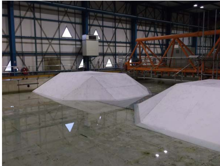
Figure III.4 – Topographie mise en place dans le bassin. Position émergée
