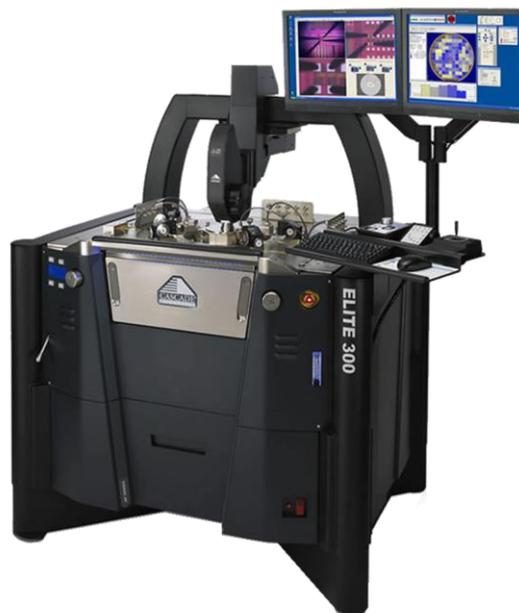
Figure IV-1 Station de test automatisée 300mm utilisée pour la caractérisation des photodiodes.
