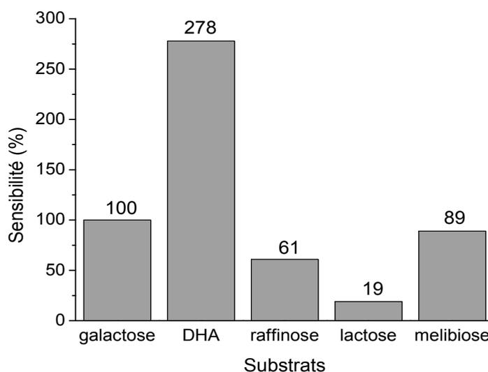
**Figure II.21 : Réponses relative du biocapteur GAOx@laponite (50:25  $\mu\text{g}:\mu\text{g}$ ) avec différents substrats (0,05 M HEPES pH 7,0,  $E_{app} = 0,6$  V/Ag-AgCl, 500 tr.min<sup>-1</sup>)**
