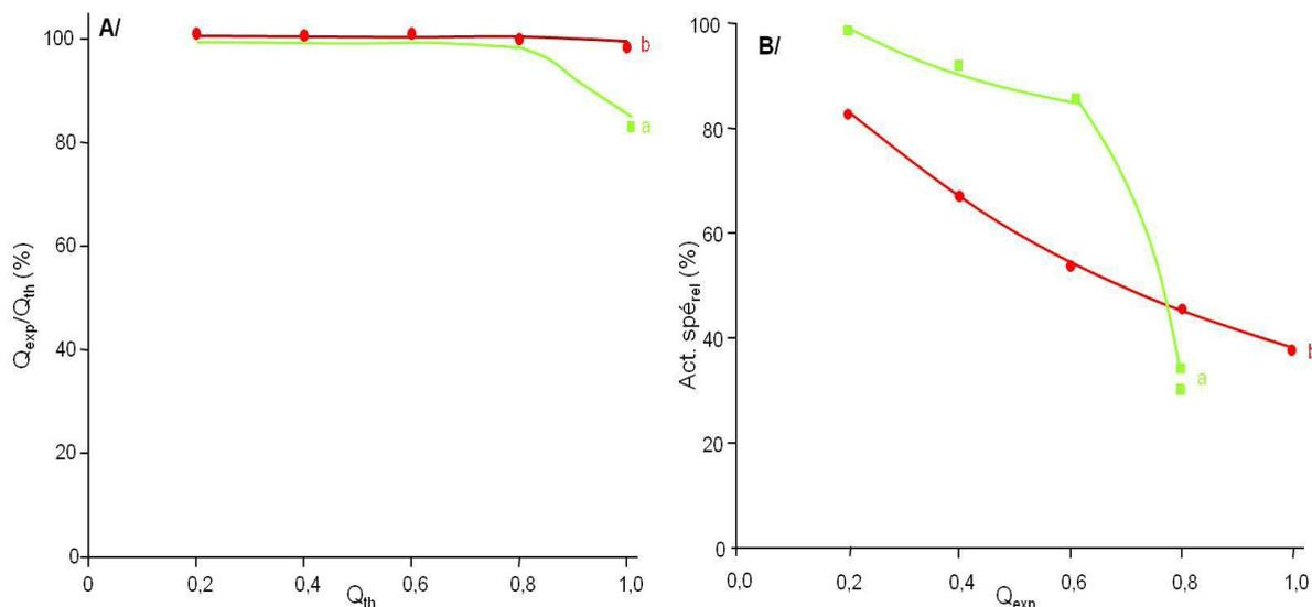
**Figure III.21 :** A/ Rendement de l'adsorption ( $Q_{exp}/Q_{th}$ ) de la TK d'*E. coli* pure en fonction de  $Q_{th}$  selon B/ Act. spé relative en fonction de  $Q_{exp}$  a) fraction  $Mg_2Al-NO_3$  fraîche b) fraction  $Mg_2Al-NO_3$  séchée (0,1 M Gly-Gly, pH 7,5, 3 h)
