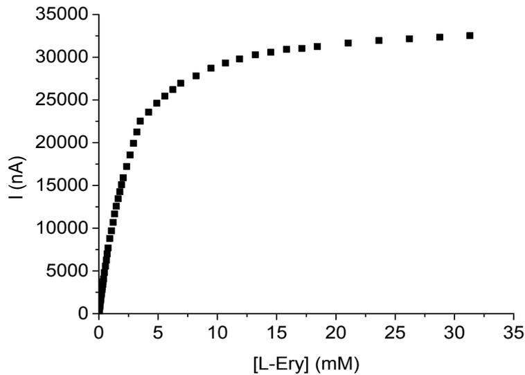
Figure II.23 : Courbe d'étalonnage du biocapteur à GAOx@laponite (50:25  $\mu\text{g}:\mu\text{g}$ ) avec le L-Ery (0,05 M HEPES pH 7,0,  $E_{\text{app}} = 0,6 \text{ V/Ag-AgCl}$ ,  $500 \text{ tr.}\cdot\text{min}^{-1}$ )
