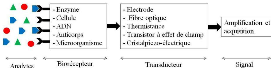
Figure I.28 : Principe de fonctionnement d'un biocapteur
