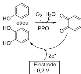
**Figure I.30 : Principe d'un biocapteur ampérométrique à PPO**
