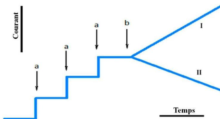
**Figure II.2 : Détection directe en chrono-ampérométrie lors de la réaction enzymatique a : ajout du produit ou du cofacteur (NADH) à doser pour l'étalonnage, b : ajout de l'enzyme, I ou II : réponse ampérométrique du produit généré ou du substrat (ou cofacteur) consommé par unité de temps<sup>14</sup>**
