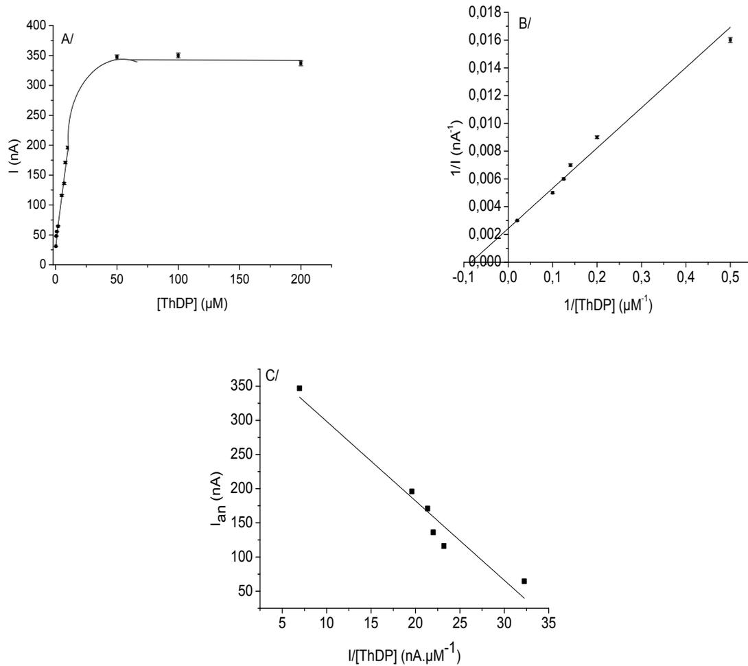
**Figure IV.7 : A/ Courbe d'étalonnage du ThDP B/ linéarisation de Lineweaver Burk C/ linéarisation de Eadie-Hofstee (0,05 M HEPES pH 7,0, 25°C, 1 mM  $\text{MgCl}_2$ , 2 mM GA, 1 mM D-F6P,  $E_{\text{app}} = 0,6 \text{ V/Ag-AgCl}$ , 500  $\text{tr}\cdot\text{min}^{-1}$ )**
