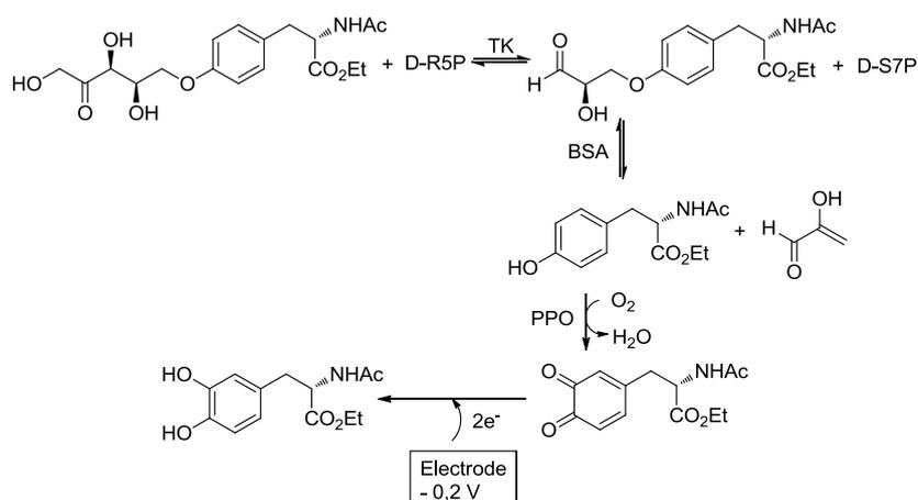
Figure I.22 : Test basé sur une détection ampérométrique
