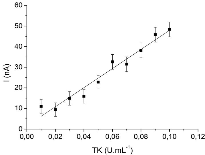
**Figure II.27 : Droite d'étalonnage de la TK d'*E. coli* avec le biocapteur GAOx@laponite (50:25 µg:µg) à 25°C (0,05 M HEPES pH 7,0, 0,2 mM ThDP, 1 mM MgCl<sub>2</sub>, 1 mM GA, 1 mM D-F6P, E<sub>app</sub> = 0,6 V/Ag-AgCl, 500 tr.min<sup>-1</sup>)**
