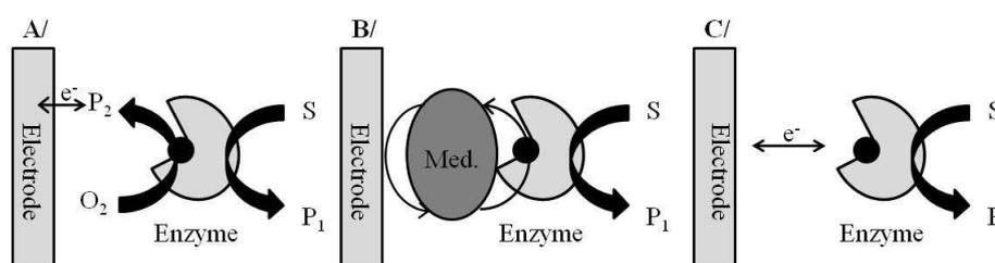
Figure I.29 : Les trois générations de biocapteurs ampérométriques A/ 1<sup>ère</sup> génération, B/ 2<sup>ème</sup> génération et C/ 3<sup>ème</sup> génération (Med. : médiateur rédox)
