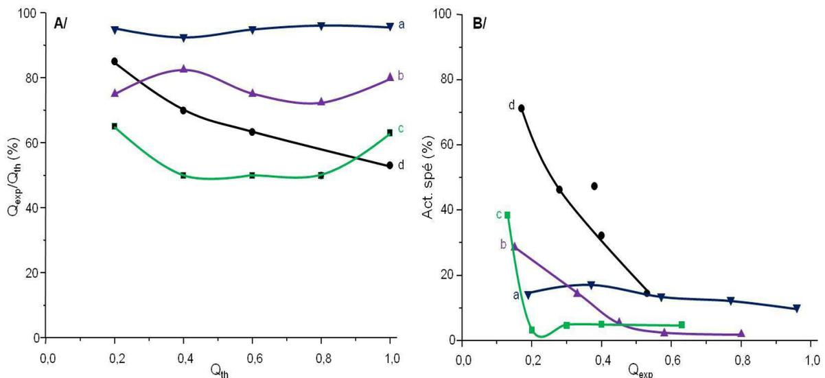
Figure III.16 : A/ Rendement de l'adsorption ( $Q_{exp}/Q_{th}$ ) de la TK d'*E. coli* en fonction de  $Q_{th}$  selon la nature de l'anion intercalé dans  $Zn_2Al-X$  et B/ Act. spé<sub>rel</sub> en fonction de  $Q_{exp}$  a)  $Zn_2Al-Alg$  b)  $Zn_2Al-MOPS$  c)  $Zn_2Al-Cl$  d)  $Zn_2Al-NO_3$  (0,05 M MOPS pH 7,5, 3 h)
