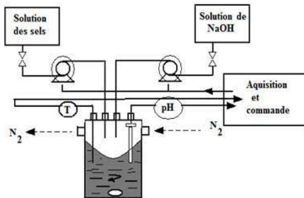
Figure I.25 : Dispositif expérimental de la synthèse des HDL par coprécipitation
