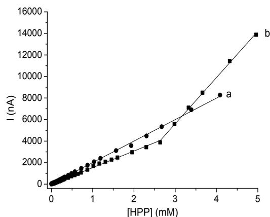
Figure IV.6 : Dosage du HPP 21 a) à l'électrode de platine b) avec le biocapteur GAOx@laponite (0,05 M HEPES pH 7,0, 25°C,  $E_{app} = 0,6$  V/Ag-AgCl, 500 tr.min<sup>-1</sup>)
