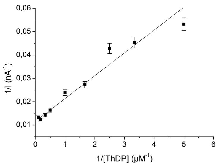
Figure II.30 : Droite d'étalonnage du ThDP avec le biocapteur GAOx@laponite (50:25 μg:μg) et la TK d'*E. coli* en solution à 25°C (0,05 M HEPES pH 7,0, 1 mM MgCl<sub>2</sub>, 1 mM GA, 1 mM D-F6P, 100 mU.mL<sup>-1</sup> TK, E<sub>app</sub> = 0,6 V/Ag-AgCl, 500 tr.min<sup>-1</sup>)
