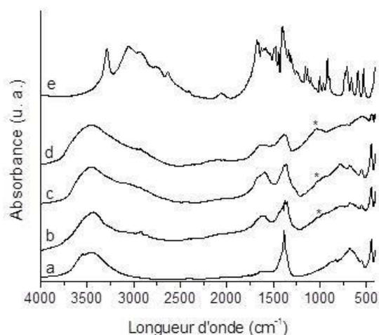
**Figure III.6 : Spectres de FTIR de a)  $\text{Mg}_2\text{Al-NO}_3$  b)  $\text{Mg}_2\text{Al-Gly-Gly}_{\text{ech}}$  pH 7,5 c)  $\text{Mg}_2\text{Al-Gly-Gly}_{\text{ech}}$  pH 9,0 d)  $\text{Mg}_2\text{Al-Gly-Gly}_{\text{cop}}$  e) Gly-Gly, \* produit parasite**
