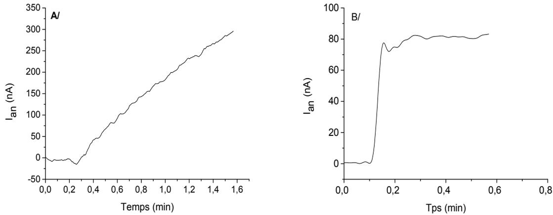
**Figure II.29 : Réponse ampérométrique du biocapteur GAOx@laponite (50:25 µg:µg) à 37°C A/ en présence de 50 mU TK d'*E. coli* B/ en présence de 100 mU TK humaine (condition identique à celle de la Figure II.27)**
