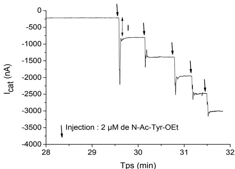
Figure II.12 : Réponse du biocapteur à PPO@Zn<sub>2</sub>Al-Alg après ajout de 5 x 2 μM de N-Ac-Tyr-OEt **3** (de 2.10<sup>-3</sup> mM à 10.10<sup>-3</sup> mM) (0,05 M MOPS pH 7,5, E<sub>app</sub> = -0,2 V/Ag-AgCl, 500 tr.min<sup>-1</sup>)
