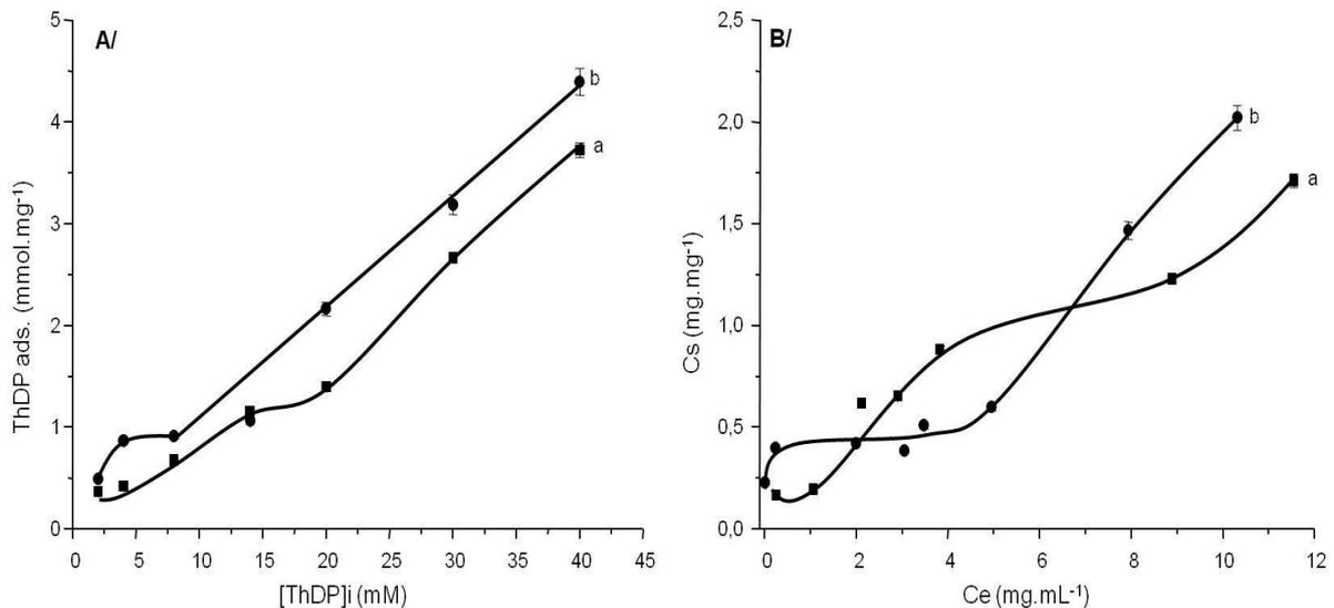
**Figure III.10 : Courbes d'adsorption du ThDP dans Mg<sub>2</sub>Al-NO<sub>3</sub> A/ [ThDP] adsorbé sur 1 mg d'HDL en fonction de la concentration initiale en ThDP ([ThDP]<sub>i</sub>) B/ Isothermes d'adsorption a) dans H<sub>2</sub>O b) dans 100 mM Gly-Gly pH 7,5**
