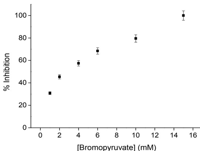
Figure IV.17 : Inhibition de la réponse ampérométrique du biocapteur GAOx-TK par le bromopyruvate **20** (0,05 M HEPES pH 7,0, 25°C, 1 mM MgCl<sub>2</sub>, 0,2 mM ThDP, 2 mM GA, 1 mM D-F6P, E<sub>app</sub> = 0,6 V/Ag-AgCl, 500 tr.min<sup>-1</sup>)
