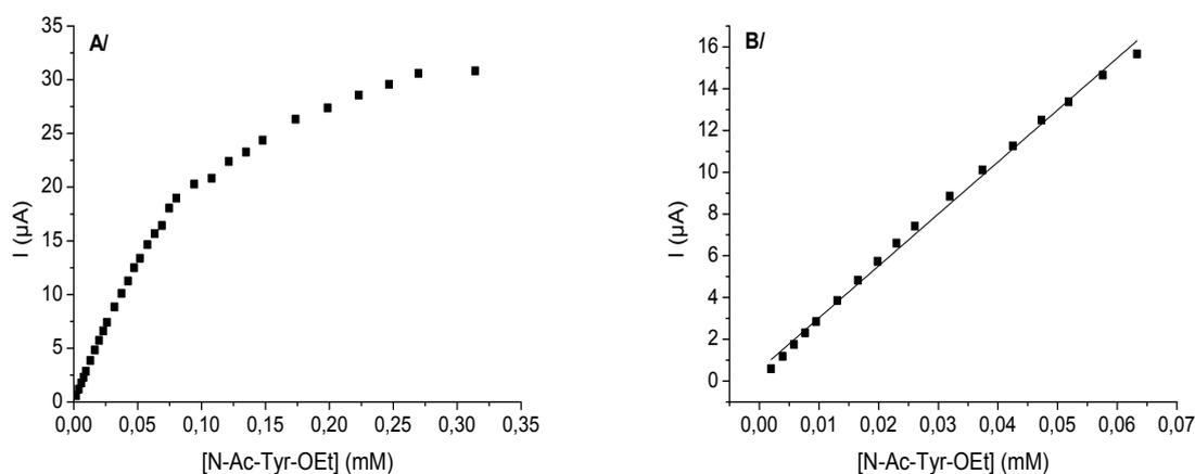
Figure II.13 : A/ Courbe d'étalonnage du biocapteur à PPO@ZnAl-Alg avec la N-Ac-Tyr-OEt **3**
