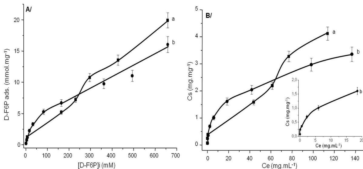
**Figure III.13 : Courbes d'adsorption du D-F6P dans  $\text{Mg}_2\text{Al-NO}_3$  A/ [D-F6P] adsorbé sur 1 mg d'HDL en fonction de la concentration initiale en D-F6P ([D-F6P]<sub>i</sub>) B/ Isothermes d'adsorption a) dans  $\text{H}_2\text{O}$  b) dans 100 mM Gly-Gly pH 7,5**
