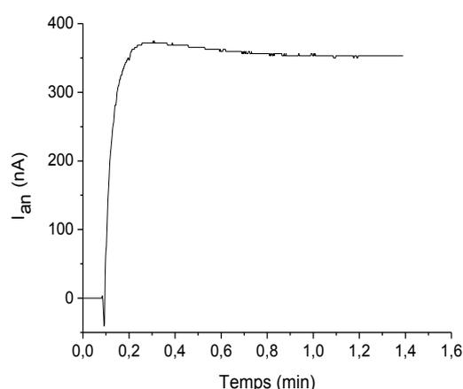
**Figure IV.3 : Réponse ampérométrique du biocapteur GAOx-TK après l'ajout de 1 mM de D-F6P (75 µg GAOx@laponite, 100 µg TK@HDL, 0,05 M HEPES pH 7,0, 25°C, 1 mM MgCl<sub>2</sub>, 0,2 mM ThDP, 2 mM GA, E<sub>app</sub> = 0,6 V/Ag-AgCl, 500 tr.min<sup>-1</sup>)**
