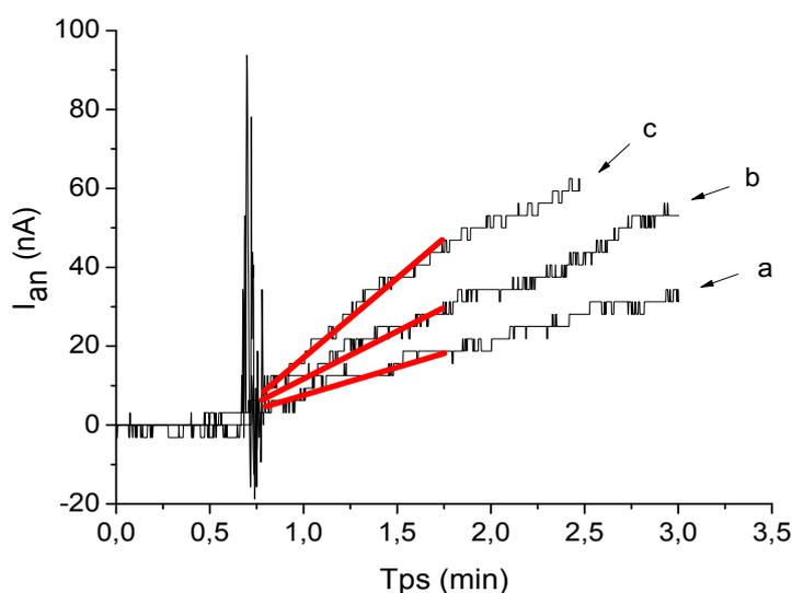
**Figure II.26 : Réponse ampérométrique du biocapteur à GAOx@laponite (50:25 µg:µg) en présence de TK *E. coli* a) 0,01 U.mL<sup>-1</sup> b) 0,04 U.mL<sup>-1</sup> c) 0,1 U.mL<sup>-1</sup> (0,05 M HEPES pH 7,0, 0,2 mM ThDP, 1 mM MgCl<sub>2</sub>, 1 mM GA, 1 mM D-F6P, E<sub>app</sub> = 0,6 V/Ag-AgCl, 500 r.min<sup>-1</sup>)**
