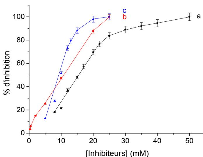
Figure IV.5 : Inhibition de la réponse ampérométrique du biocapteur GAOx@laponite par différentes molécules a) thiamine monophosphate **15** b) thiamine **14** c) ThDP **16** (0,05 M HEPES pH 7,0, 25°C, 3 ajouts de 5  $\mu$ M DHA,  $E_{app} = 0,6$  V/Ag-AgCl, 500 tr.min<sup>-1</sup>)
