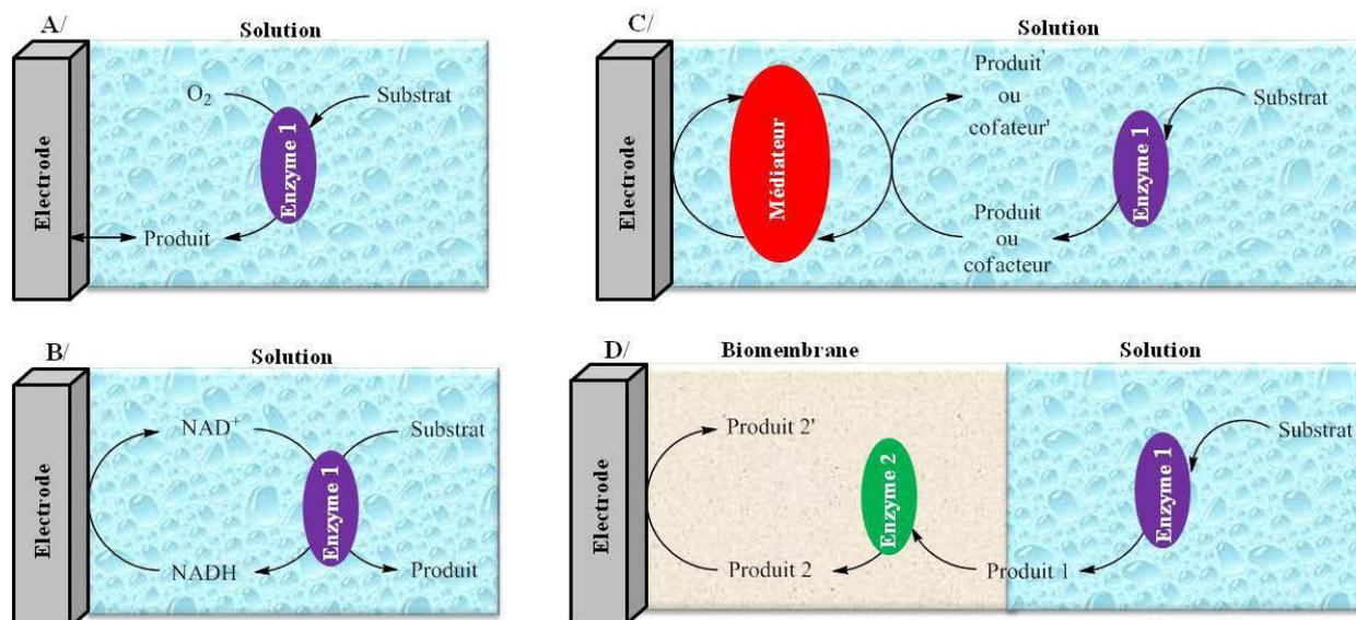
**Figure II.1 : Détermination de l'activité enzymatique en solution par voie électrochimique A/ Détection directe du produit B/ Détection du cofacteur C/ Détection avec un médiateur redox, qui peut être soit en solution, soit immobilisé D/ Détection avec une enzyme auxiliaire immobilisée**
