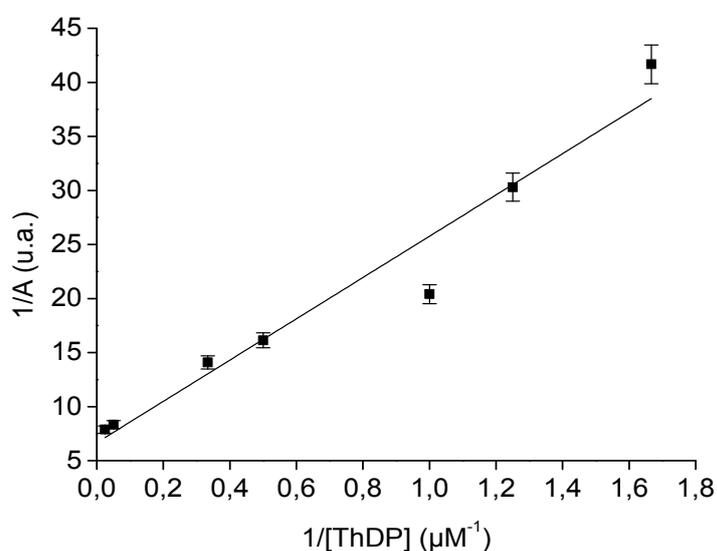
Figure II.31 : Droite d'étalonnage du ThDP en UV-Visible avec la TK d'*E. coli* en solution à 25°C (0,1 M Gly-Gly pH 7,5, 0,5 mM MgCl<sub>2</sub>, 85 mM L-Ery, 8,9 mM D-R5P, 0,3 mM NADH, 2 U.mL<sup>-1</sup> TK, 25 U YADH)
