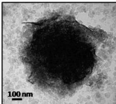
Figure I.26 : Image par microscopie électronique à transmission du biohybride HDL@hémoglobine<sup>107</sup> (au centre de l'image : agrégat de protéines recouvert de petites plaquettes hexagonales d'HDL)
