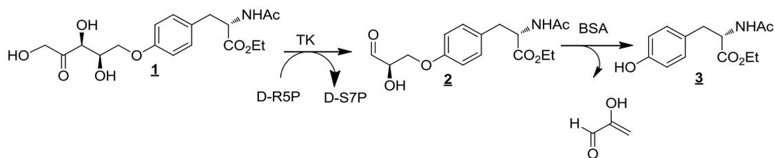
Figure II.8 : Réactions suivies par VC
