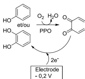
Figure II.11 : Réaction catalysée par la PPO suivie d'une réduction électrochimique
