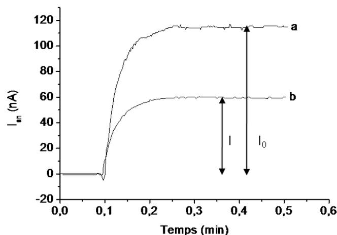
Figure IV.4 : Réponse ampérométrique du biocapteur GAOx-TK en a) l'absence d'inhibiteur b) présence de 50  $\mu\text{M}$  de pyrophosphate (75  $\mu\text{g}$  GAOx@laponite, 100  $\mu\text{g}$  TK@HDL, 0,05 M HEPES pH 7,0, 25°C, 1 mM  $\text{MgCl}_2$ , 5  $\mu\text{M}$  ThDP, 2 mM GA,  $E_{\text{app}} = 0,6$  V/Ag-AgCl, 500  $\text{tr}\cdot\text{min}^{-1}$ )
