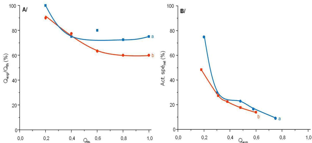
**Figure III.19 : A/ Rendement de l'adsorption ( $Q_{exp}/Q_{th}$ ) de la TK d'*E. coli* en fonction de  $Q_{th}$  selon l'argile B/ Act. spé relative en fonction de  $Q_{exp}$  a)  $Mg_2Al-NO_3$  b) laponite (0,05 M MOPS pH 7,5, 3 h)**
