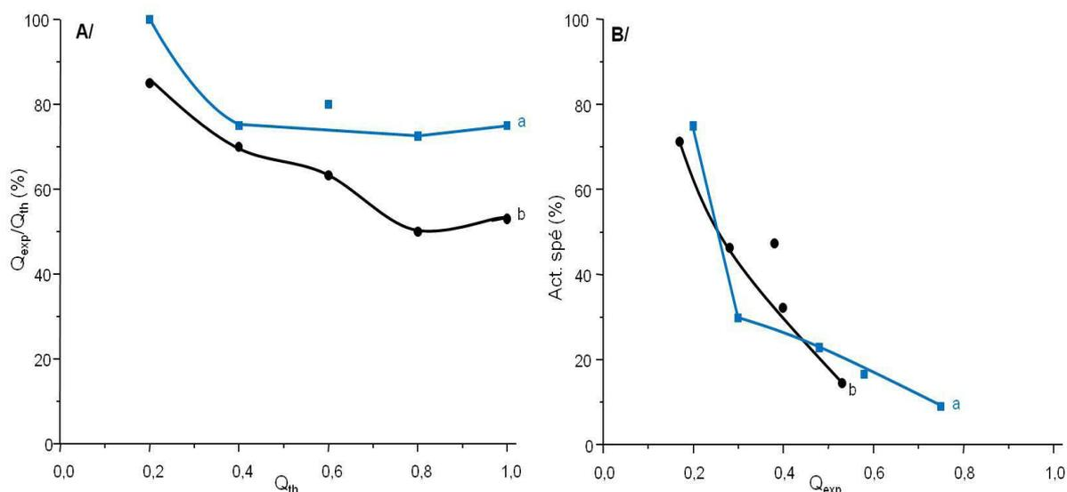
**Figure III.18 : A/ Rendement de l'adsorption ( $Q_{exp}/Q_{th}$ ) de la TK d'*E. coli* en fonction de  $Q_{th}$  selon la nature du  $M^{II}$  avec le contre ion nitrate B/ Act. spé<sub>rel</sub> en fonction de  $Q_{exp}$  a)  $Mg_2Al-NO_3$  b)  $Zn_2Al-NO_3$  (0,05 M MOPS pH 7,5, 3 h)**
