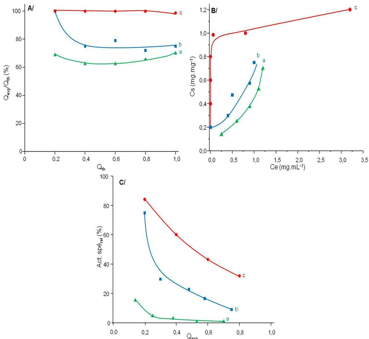
**Figure III.20 :** A/ Rendement de l'adsorption ( $Q_{exp}/Q_{th}$ ) de la TK d'*E. coli* pure en fonction de  $Q_{th}$  selon la nature du milieu B/ Isothermes d'adsorption C/ Act. spé<sub>rel</sub> en fonction de  $Q_{exp}$  a) H<sub>2</sub>O b) 50 mM MOPS c) 100 mM Gly-Gly (Mg<sub>2</sub>Al-NO<sub>3</sub>, pH 7,5, 3 h)
