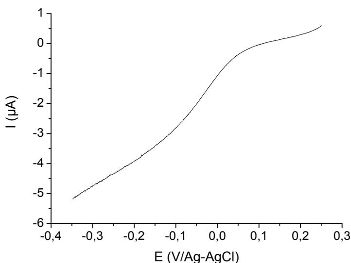
**Figure II.14 :** Courbe de voltammétrie linéaire avec la bioélectrode PPO@Zn<sub>2</sub>Al-Alg, 25/25 µg/µg (0,05 M MOPS pH 7,5, 2 mM ThDP, 3 mM MgCl<sub>2</sub>, 2 mg.mL<sup>-1</sup> BSA, 100 µM composé **1**, 5 U TK *E. coli*,  $\nu = 10 \text{ mV.s}^{-1}$ )
