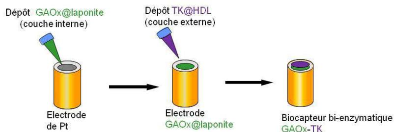
Figure IV.2 : Formation en bicouche du biocapteur bi-enzymatique GAOx-TK
