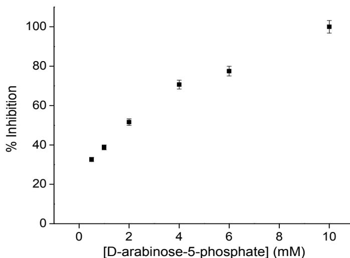
Figure IV.15 : Inhibition de la réponse ampérométrique du biocapteur GAOx-TK par le D-arabinose-5-phosphate **22** (0,05 M HEPES pH 7,0, 25°C, 1 mM MgCl<sub>2</sub>, 0,2 mM ThDP, 2 mM GA, 1 mM D-F6P,  $E_{app} = 0,6$  V/Ag-AgCl, 500 tr.min<sup>-1</sup>)
