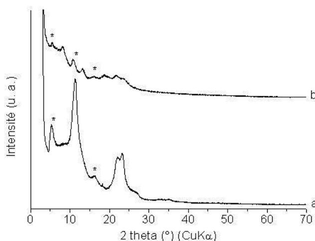
Figure III.11 : Diffractogrammes de RX de l'adsorption du ThDP dans  $Mg_2Al-NO_3$  a) H<sub>2</sub>O b) 100 mM Gly-Gly \* Insertion du ThDP
