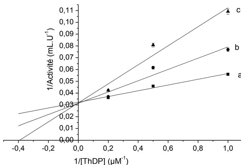
Figure IV.10 : Etude en spectrophotométrie de l'inhibition de l'apo-TK non immobilisée par le pyrophosphate **17** a) sans b) 40 μM c) 300 μM (0,1 M Gly-Gly pH 7,5, 25°C, 0,5 mM MgCl<sub>2</sub>, 85 mM L-Ery, 8,9 mM D-R5P, 0,3 mM NADH, 2 U.mL<sup>-1</sup> TK, 25 U YADH)
