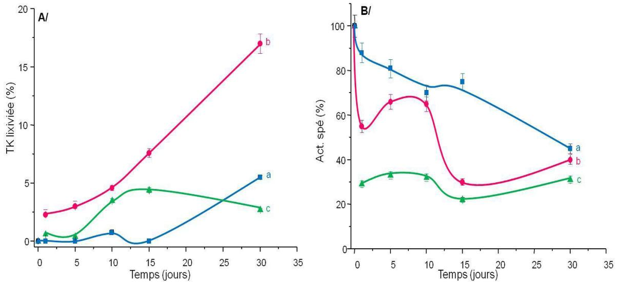
Figure III.25 : Caractéristique du biohybride TK@Mg<sub>2</sub>Al-Gly-Gly<sub>cop</sub> dans Gly-Gly 25 mM conservé A/ relargage de la TK en fonction du temps B/ Act.spé.rel en fonction du temps a) sous forme d'une suspension à 4°C b) sous forme d'une suspension congelé à -18°C c) sous forme lyophilisé
