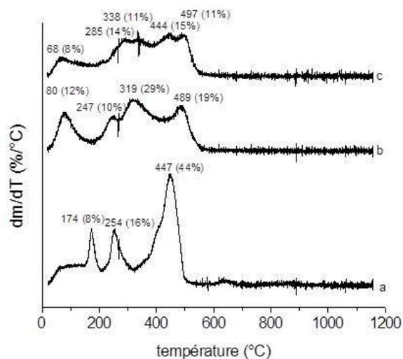
Figure III.24 : Thermogravimétrie différentielle (DTG) de a) Mg<sub>2</sub>Al-Gly-Gly<sub>cop</sub> b) TK@Mg<sub>2</sub>Al-Gly-Gly<sub>cop</sub> c) TK@Mg<sub>2</sub>Al-Gly-Gly<sub>ads</sub>
