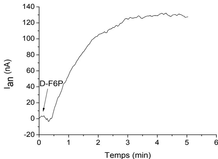
**Figure II.25 :** Allure logarithmique de la réponse ampérométrique avec la TK d'*E. coli* (GAOx@laponite 50:25  $\mu\text{g}:\mu\text{g}$ , 0,05 M HEPES pH 7,0, 0,2 mM ThDP, 1 mM  $\text{MgCl}_2$ , 1 mM GA, 1 mM D-F6P, 1 U.mL<sup>-1</sup>,  $E_{\text{app}} = 0,6 \text{ V/Ag-AgCl}$ , 500 r.min<sup>-1</sup>)
