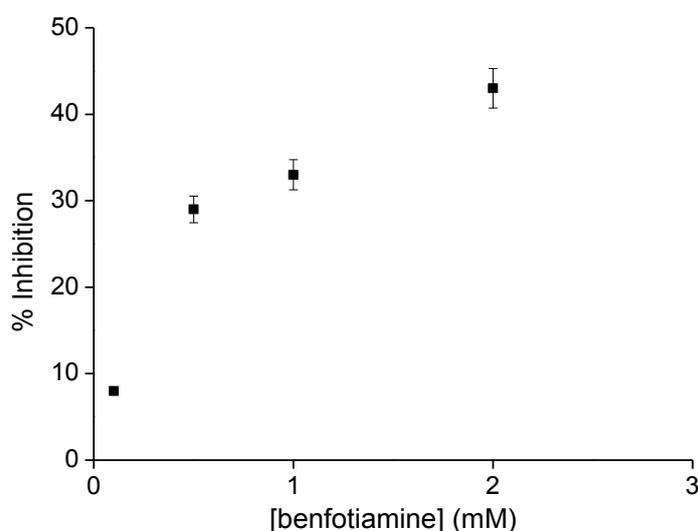
Figure IV.13 : Inhibition de la réponse ampérométrique du biocapteur GAOx-TK par la benfotiamine **19** (0,05 M HEPES pH 7,0, 25°C, 1 mM MgCl<sub>2</sub>, 5 μM ThDP, 2 mM GA, 1 mM D-F6P, E<sub>app</sub> = 0,6 V/Ag-AgCl, 500 tr.min<sup>-1</sup>)
