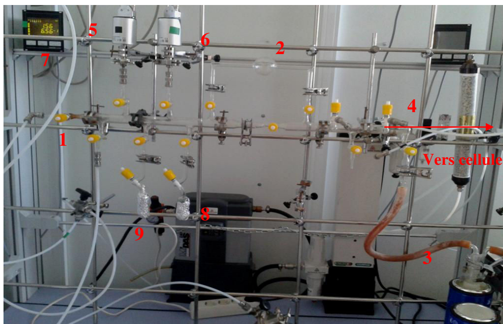
Figure 2.23: Photo du système d'introduction des réactifs utilisé à UCLM
