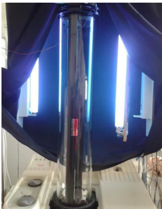
Figure 2.21: Photo de la cellule IR et le système de photolyse utilisé
