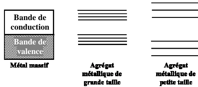
Figure I-13 Structure électronique d'un îlot métallique en fonction de sa taille.
