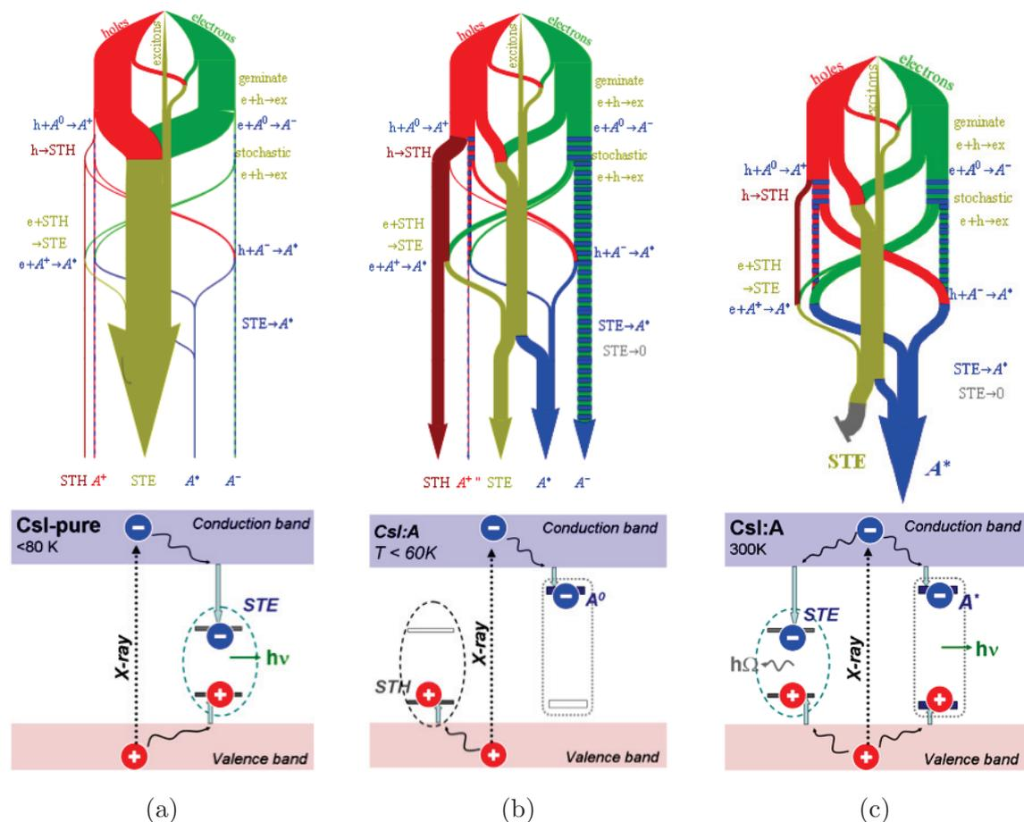
Figure R3: *Présentation graphique des chaînes de la relaxation d'énergie (en haut) et des chaînes de transfert vers le centre luminescent pour a - pure CsI, b - CsI:Tl à  $T < 60K$  et c - CsI:Tl à 300 K*
