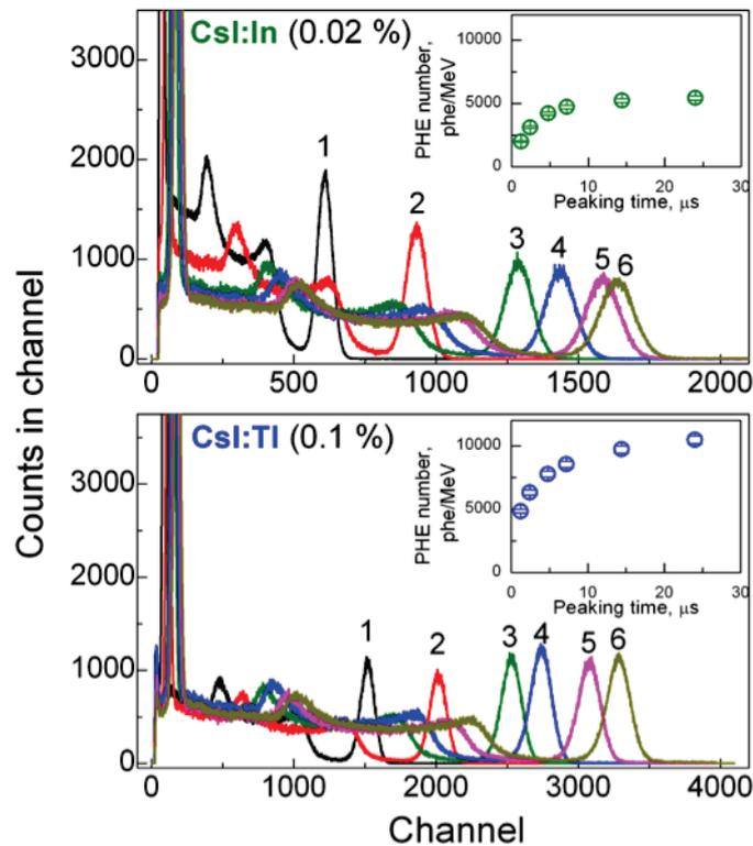
Figure R2: Les spectres des amplitudes des scintillation de CsI:In (a) et de CsI:Tl (b) mesurés sous excitation de  $^{137}\text{Cs}$   $\gamma$  de 661.6 keV et pour les temps intégration variés
