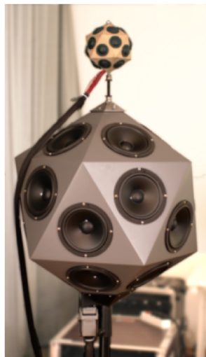
Figure 37. Source icosaédrique à 20 x2 voies (+ 1 caisson BF) développée par l'IEM
