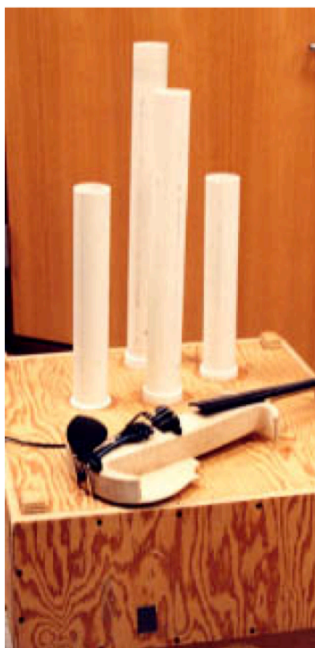
Figure 32. DTC loudspeaker – Dispositif expérimental élaboré par G. Weinreich pour restituer le rayonnement caractéristique d'un signal de violon [Weinreich, 1997b]
