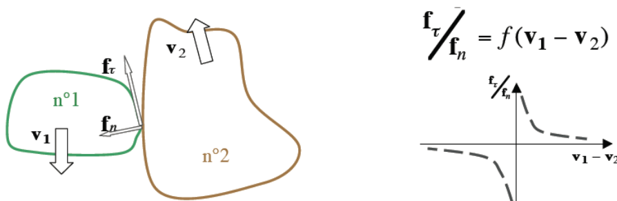
Figure 2. Illustration de la connexion (interaction) 'frotter' dans Modalys. f_n et f_t sont resp. les forces normale et tangentielle au point de contact ; v_1 et v_2 les vitesses respectives des deux objets en contact
