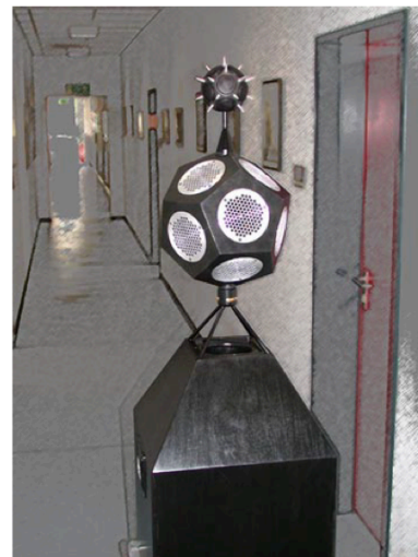
Figure 38. Source dodécaédrique à 12 x2 voies (+ 1 caisson BF) développée par l'ITA
