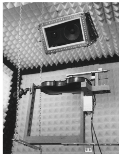
Figure 30. Mesure du rayonnement acoustique par une méthode indirecte [Weinreich, 1997] Expérience sur le violon (seul le haut-parleur en position frontale par rapport à la table est visible).
