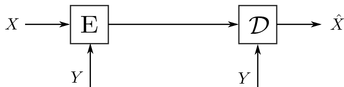
FIGURE 2.1 – Codage de la source X avec l'information adjacente Y disponible au codeur et au décodeur
