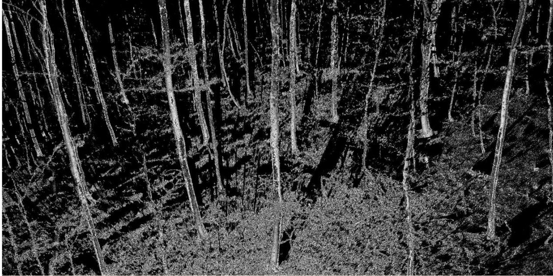
Figure 28 : Scan d'une placette avec un Faro Photon 120
